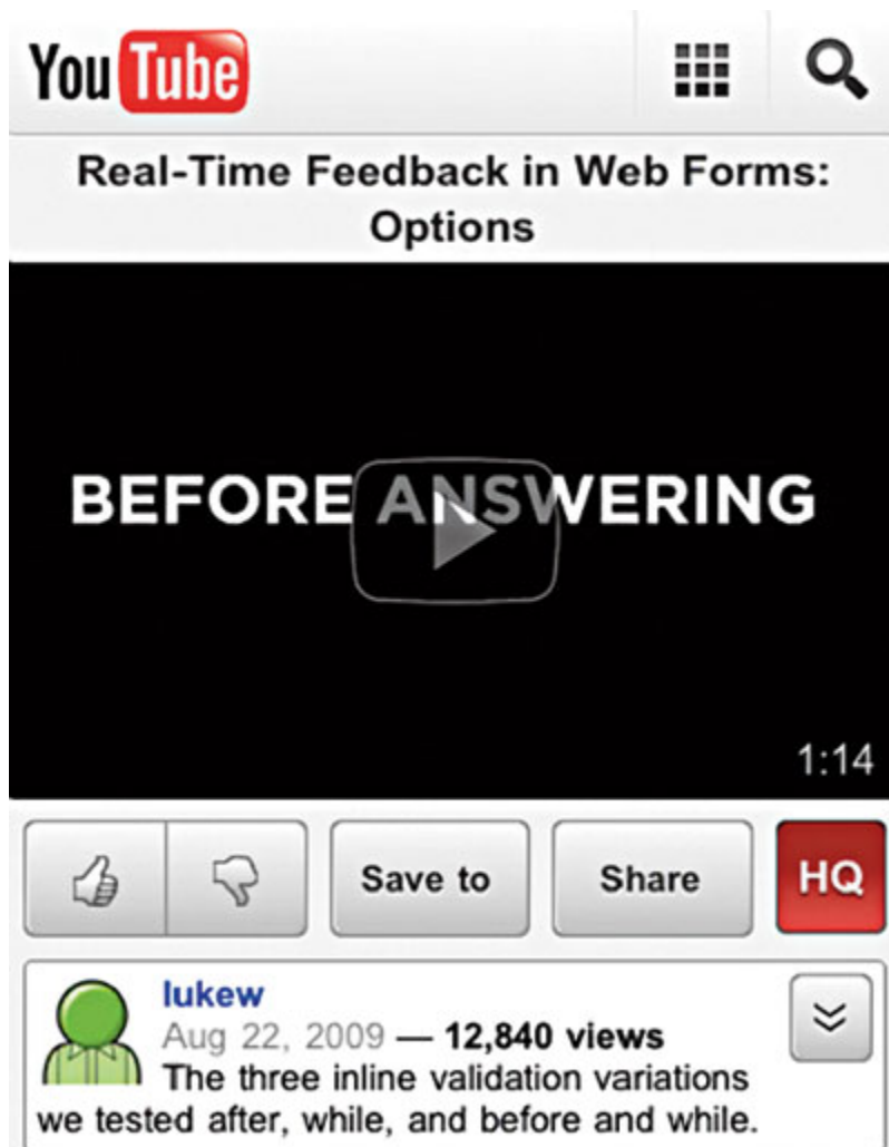
Рис. 5.2. Активные кнопки на сайте YouTube, достаточно крупные для того, чтобы на них можно было безошибочно нажимать одним пальцем
