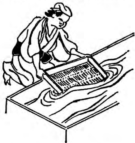
Форма для производства бумаги, погруженная в бадью с бумажным раствором
