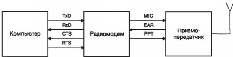
Рис. 4.22. Схема применения радиомодема в составе станции пакетной связи
