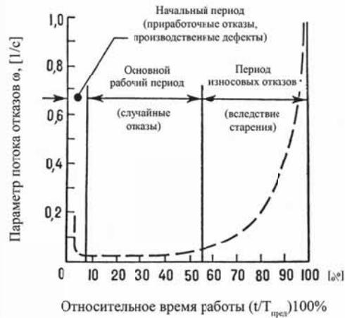
Рис. 10.19. Зависимость параметра потока отказов от длительности функционирования изделия
