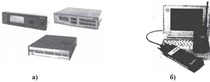
Рис. 4.21. а) внешний вид пакетных радиомодемов; б) сотовый аналоговый модем ZyXEL-1496P
