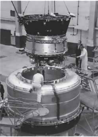
Рис. 12.2. Монтаж разгонного блока «Бриз-М»
