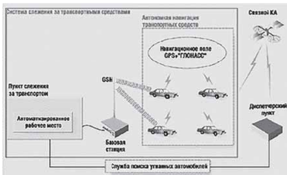
Рис. 4.9. Схема мониторинга подвижных объектов
