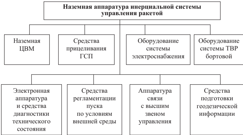
Рис. 9.2. Состав наземной аппаратуры инерциальной системы управления межконтинентальных баллистических ракет
