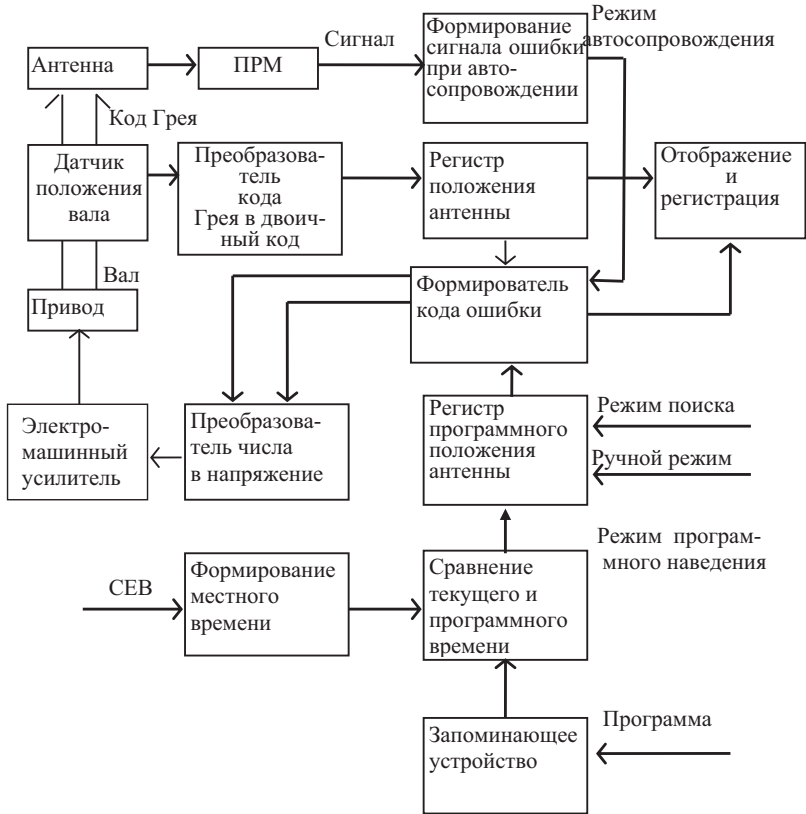
Рис. 4.13. Типовая структурно-функциональная схема системы наведения параболической антенны по одной из угловых координат
