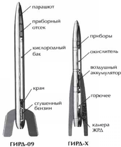
Рис. 5.2. Внешний вид и устройство ракет ГИРД-09 и ГИРД-X
