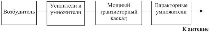
Рис. 4.11. Типовая структурная схема полупроводникового передатчика в диапазоне дециметровых и сантиметровых волн
