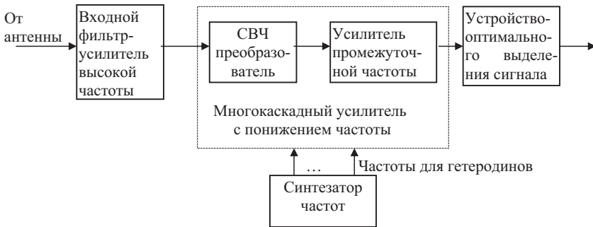
Рис. 4.12. Типовая структурная схема приемника КИС
