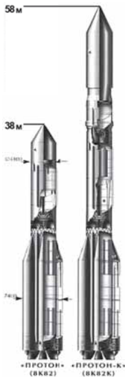
Рис. 5.12. Внешний вид и компоновка ракеты-носителя «Протон»
