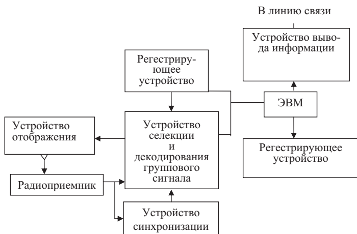
Рис. 10.7. Состав приёмно-регистрающей аппаратуры и аппаратуры обработки информации
