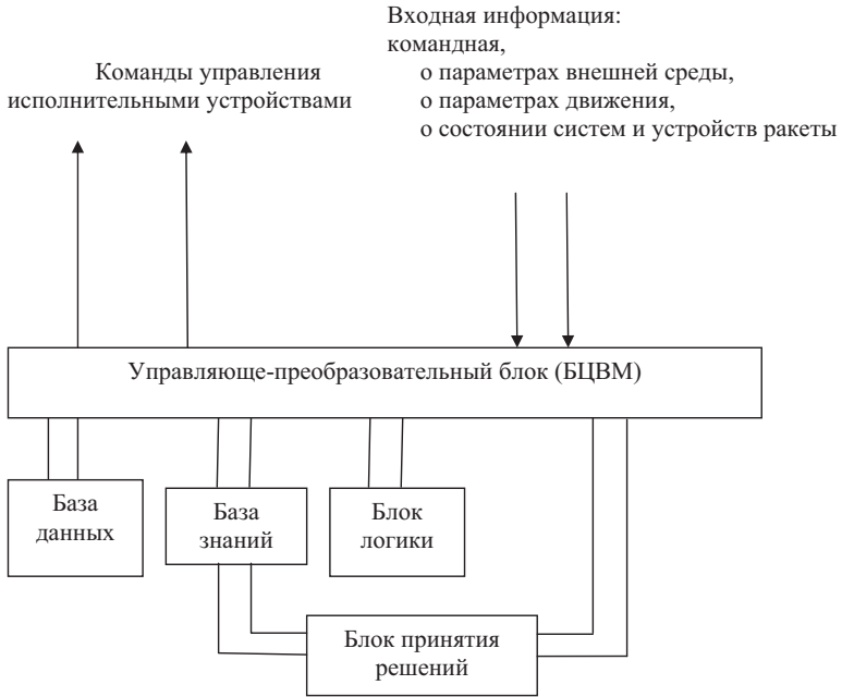
Рис. 9.15. Блок-схема построения вычислительных средств СУ с ИИ
