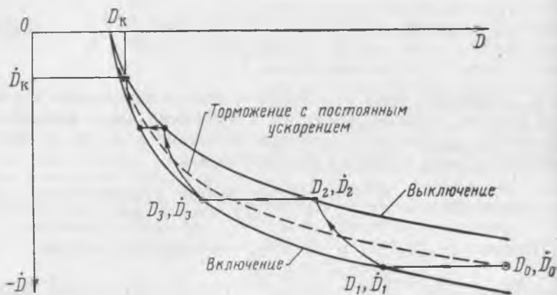
Рис. 3. 43. Параболические линии переключения в плоскости \dot{D}-D
