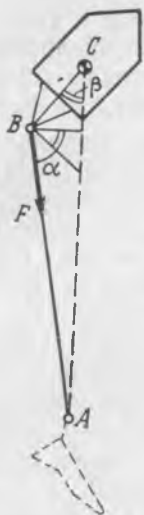
Рис. 4. 15. Схема возникновения колебаний вокруг центра масс цели после встречи с захватом:
