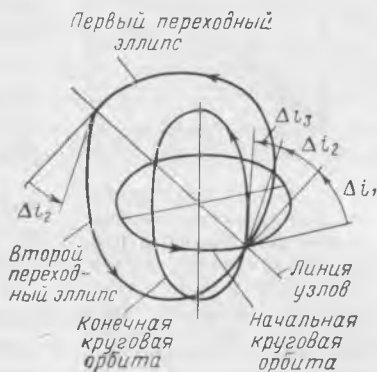
Рис. 2.16. Поворот плоскости орбиты с помощью нескольких последовательных импульсов
