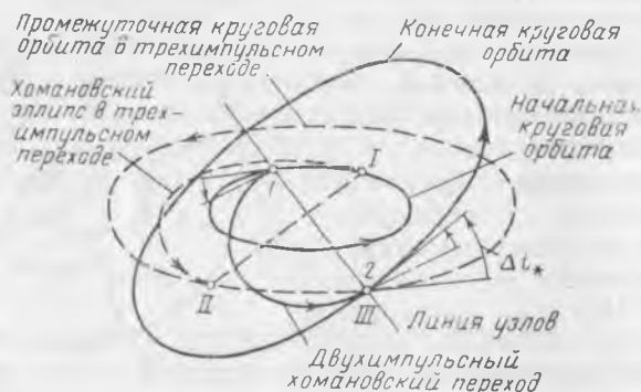
Рис. 2. 19. Пространственные модификации хомановского перехода:
