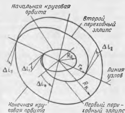
Рис. 2.18. Биэллиптический трехимпульсный переход
