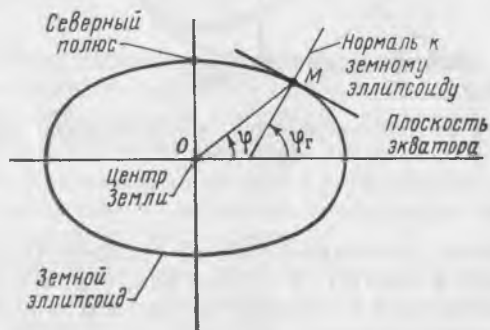
Рис. 2. 3. Геодезическая система координат
