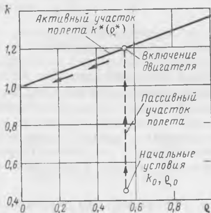
Рис. 3.17. Условие переключения для одномерного сближения при минимальном расходе топлива с учетом переменности массы
