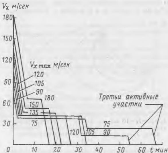
Рис. 3.12. Пример изменения характеристической скорости перехватчика V_x для оптимального по продолжительности сближения ( a_{\max}=0,3 м/сек 2 ; x_0=y_0=z_0=18 км; \dot{x}_0=\dot{y}_0=\dot{z}_0=30 м/сек)
