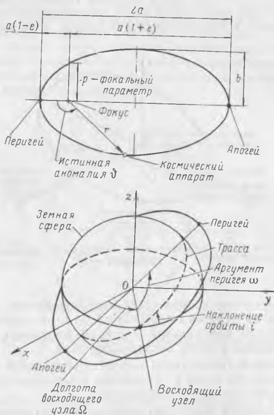
Рис. 2.6. Орбитальные элементы (эллиптическая орбита)
