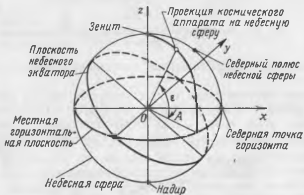
Рис. 2.4. Топоцентрическая горизонтальная система координат
