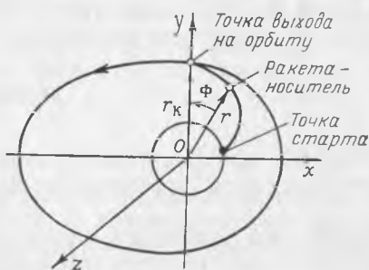
Рис. 2.28. Орбитальная система координат, применяемая для исследования наведения ракеты-носителя
