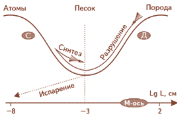
Рис. 2.16. Горная порода разрушается под воздействием естественных природных факторов, постепенно превращаясь в камни, гравий, песок, пыль. Пунктиром показан дальнейший ее гипотетический путь — разрушение вплоть до атомов (испарение), чего не происходит из-за наличия перегиба в потенциальной яме устойчивости в области размеров около 10 мкм. Пылинки, достигшие левого склона ямы, начинают обратное движение в фазовом пространстве, слипаясь в осадочные породы
