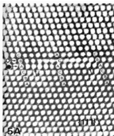
Рис. 1.24. Кристаллическая решетка золота. Фотография, сделанная с помощью электронного микроскопа. Каждая белая точка — атом золота, расположенный в кристаллографической плоскости
