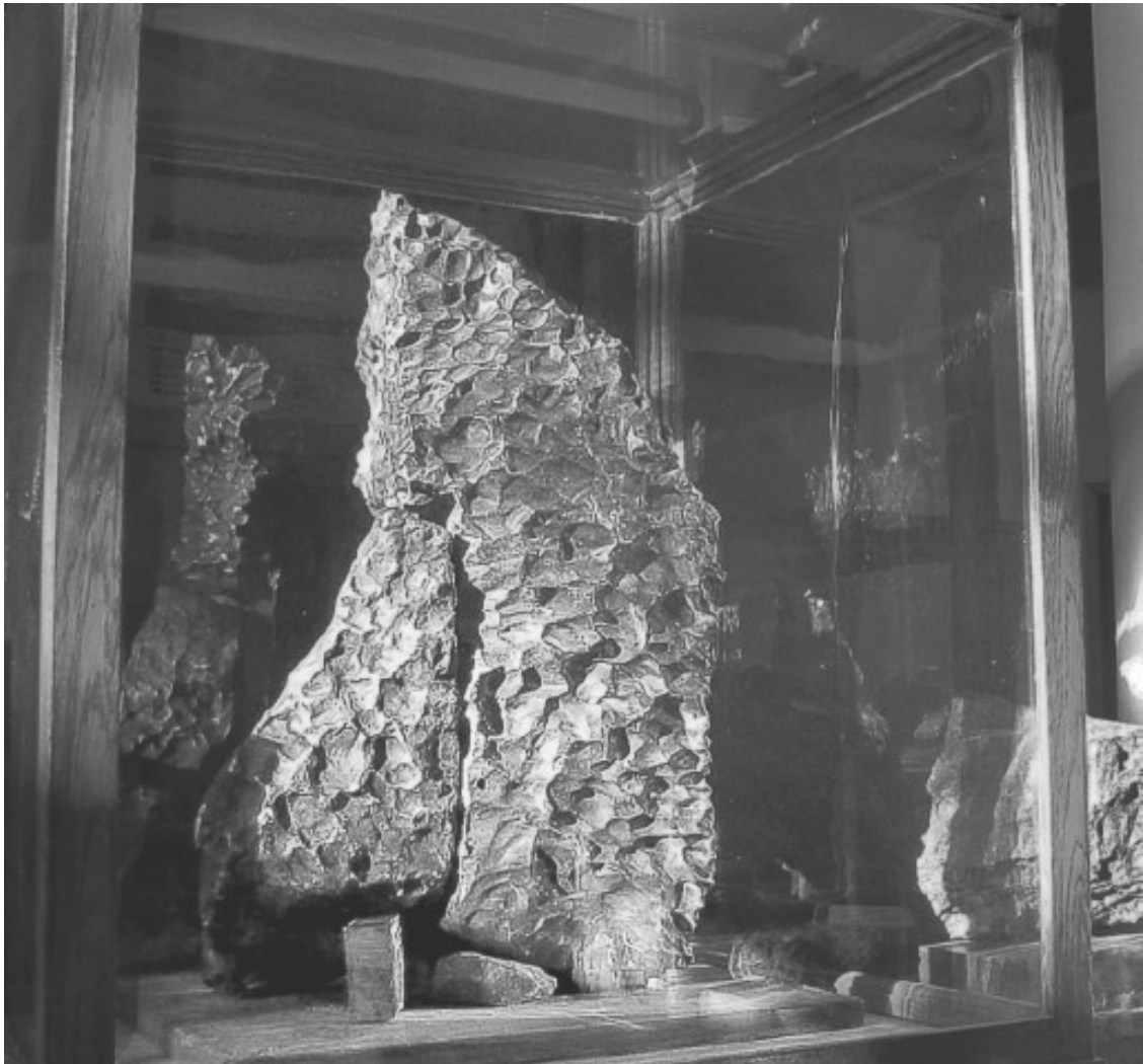
Рис. 17. Железный метеорит Богуславка – кристалл железа, расколовшийся по спайности
