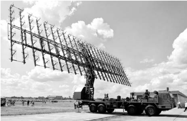
Рис. 38. Российская радиолокационная станция метрового диапазона Небо-М.
