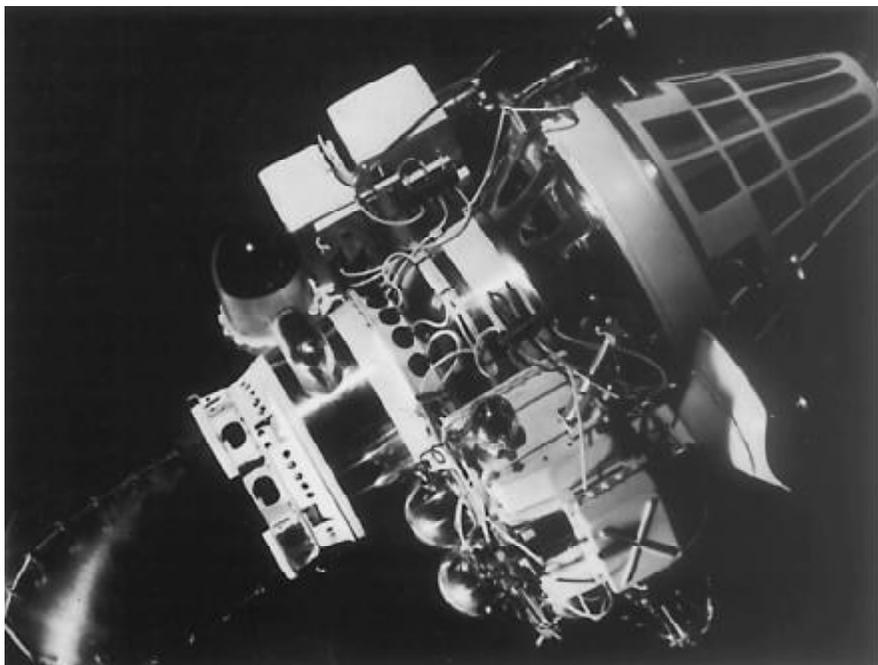
Рис. 97. Автоматическая межпланетная станция «Луна-9»
