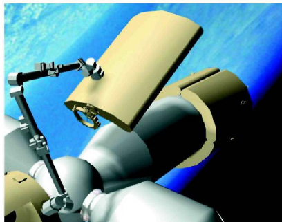
Рис. 8.2 Установка баков с рабочим телом на жилой модуль
