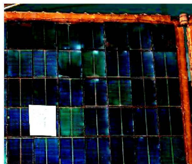
Рис. 5.47 Секция СБ с почерневшими фотоэлементами
