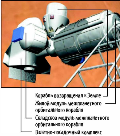
Рис. 3.14 Взаимное расположение модулей межпланетного орбитального корабля, взлетно-посадочного комплекса, корабля возвращения к Земле и других элементов
