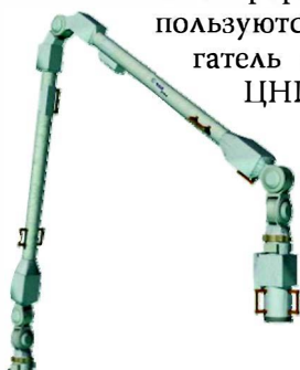
Рис. 9.4 Манипулятор «Эра» на российском сегменте МКС (разработка ESA)
