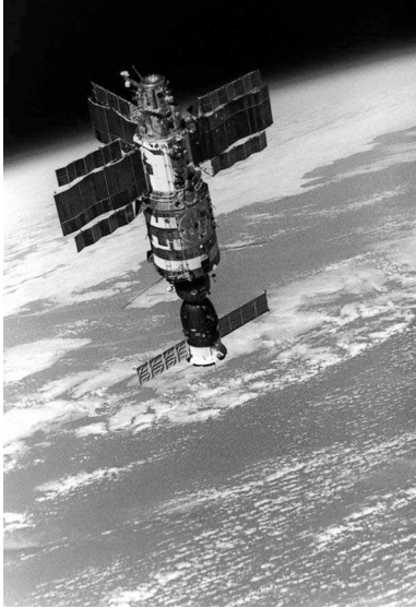
Рис. 6.7. Орбитальная станция «Салют-7» с пристыкованным кораблем «Союз Т-6», дооснащенная в ходе полета дополнительными солнечными батареями
