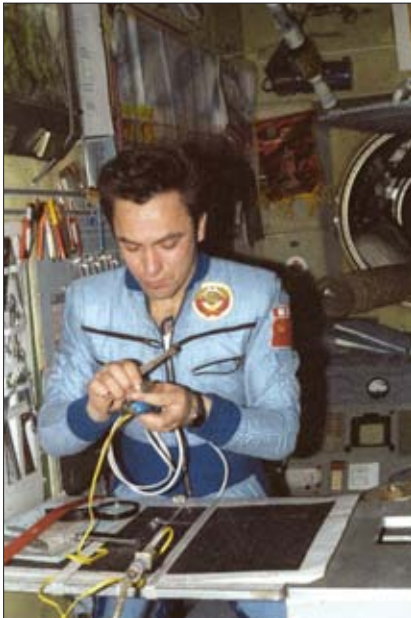
Леонид Попов за разборкой разъемов бортовой кабельной сети. Ищет неисправность
