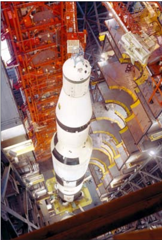
Сборка PH Saturn 5 (SA-501) в Здании вертикальной сборки VAB Центра Кеннеди
