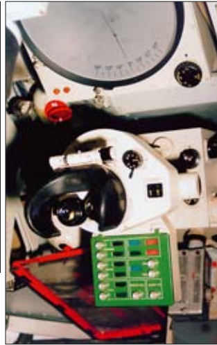
Центр управления и контроля станции с оптическим устройством ОД-4 и визирами – панорамно-обзорного устройства (справа внизу, а также на фото справа) и перископа кругового обзора «Сокол» (справа вверху)
