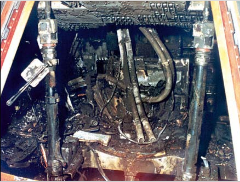
Так выглядела кабина «Аполлона» после пожара
