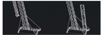
Задачи 6-го выхода: демонтаж «Рапаны» (слева) и установка на ее месте фермы «Стромбус»
