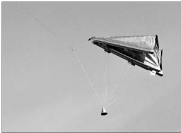
Испытания крыла-параглайдера для «Джемини»
