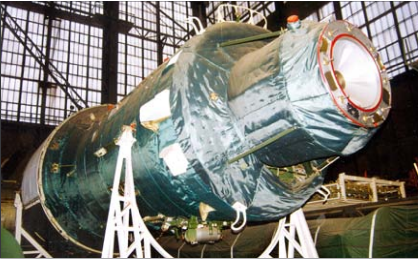
Передняя часть ОПС-4 с дополнительным узлом стыковки с ТКС
