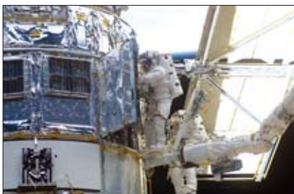
Джон Грунсфелд и Ричард Линнехан проводят замену блока управления питания
