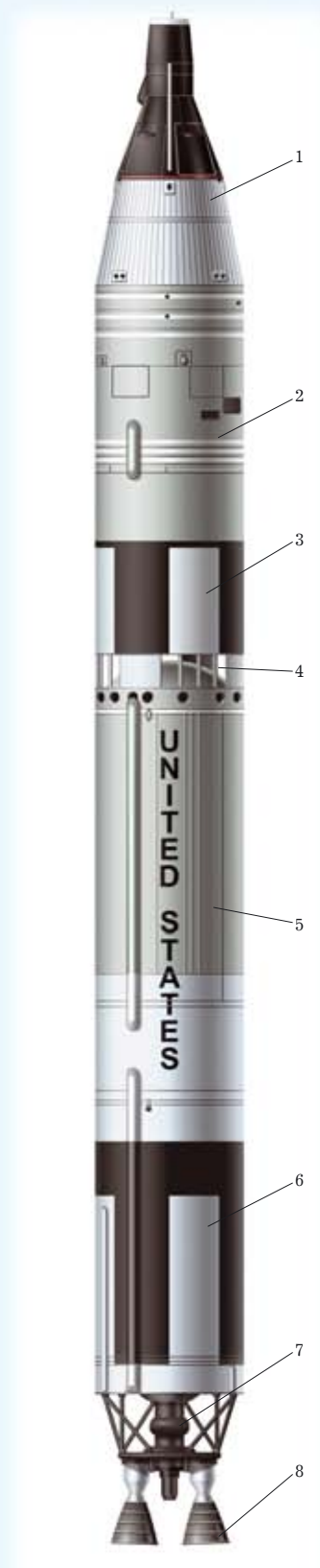
Ракета-носитель «Титан-2»: 1 – корабль «Джемини»; 2 – баковый отсек второй ступени; 3 – хвостовая юбка второй ступени; 4 – отверстия для выхода газов при запуске ЖРД второй ступени; 5 – бак окислителя; 6 – бак горючего; 7 – ТНА двигателя; 8 – камеры двигателей первой ступени
