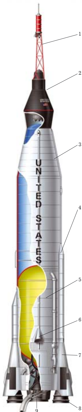
1 – САС; 2 – капсула «Меркурий»; 3 – бак окислителя; 4 – приборный отсек; 5 – бак горючего; 6 – рулевая камера; 7 – сбрасываемый хвостовой отсек; 8 – стартовые двигатели; 9 – маршевый двигатель
