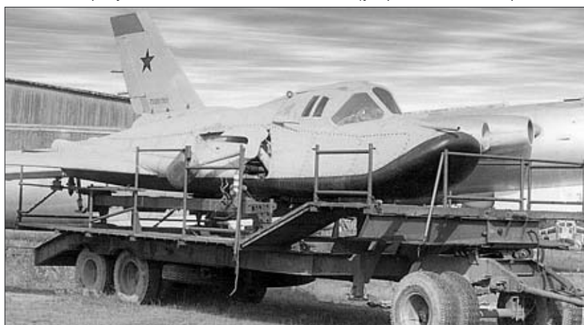
Дозвуковой самолет-аналог проекта «Спираль» («105.11»)
