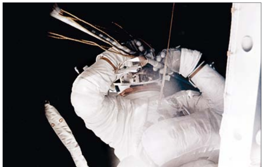
С помощью резака Кервин помогает раскрыться солнечной батарее
