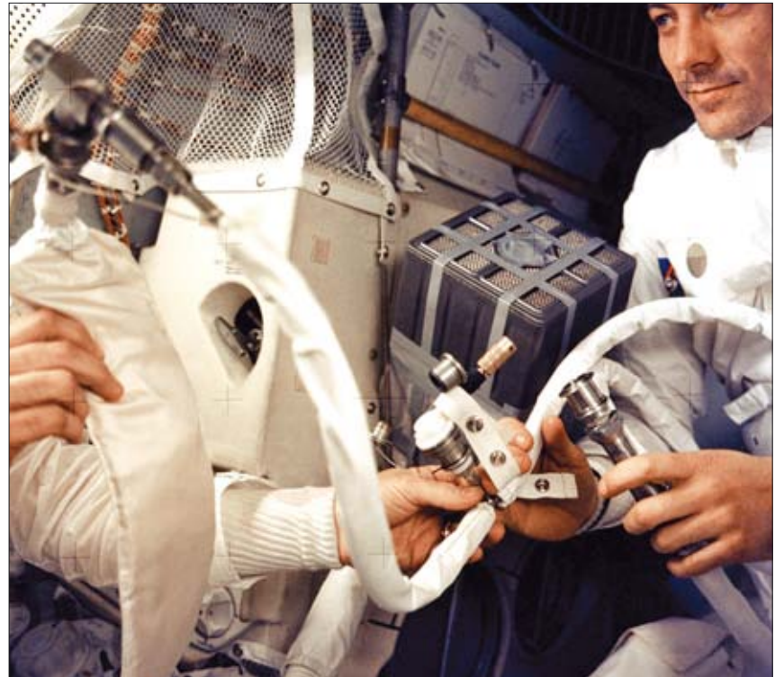
В руках у Джона Свайгерта – изготовленный на борту корпус для поглотителя CO 2
