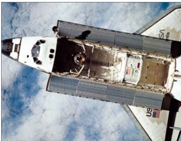
Грузовой отсек. Створки, содержащие радиаторы, в полете открыты
