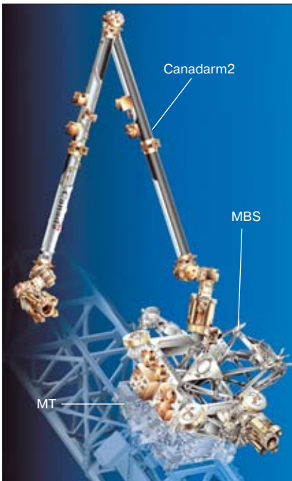
После всех работ команды STS-111 «железная дорога» МКС обросла полезной нагрузкой – на транспортер (MT) установили Мобильную базовую систему (MBS), способную нести манипулятор Canadarm2
