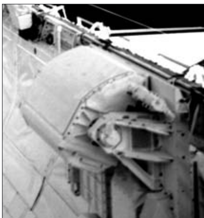
Рентгеновский спектрометр DXS на стенке грузового отсека
