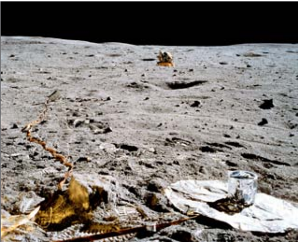
T+122:14. Приборы комплекса ALSEP №5. Справа – пассивный сейсмометр, слева на конце кабеля – mortar для активного зондирования грунта. Вдали стоит «Орион»
