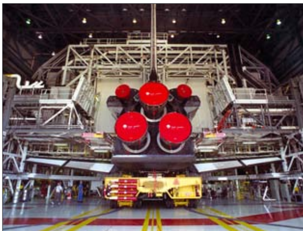
Хвостовой отсек шаттла. Хорошо видны три маршевых двигателя SSME и два ЖРД орбитального маневрирования OMS
