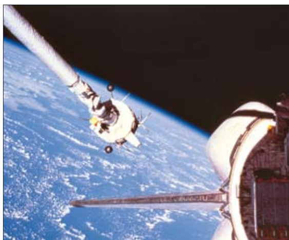
На конце манипулятора – комплект инструментов для диагностики околоземной плазмы (PDP)
