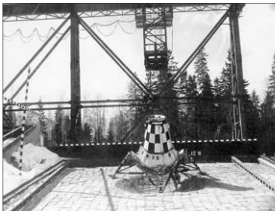
На специальном стенде отработывались условия посадки
