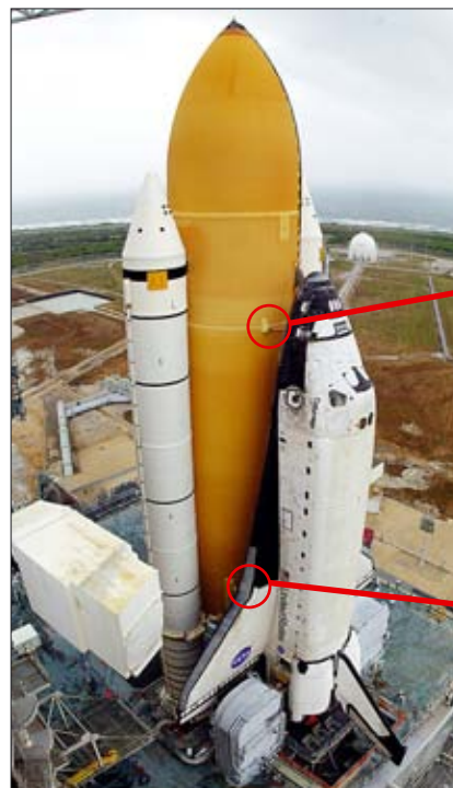
Вверху: отсюда сорвался кусок пены Внизу: наиболее вероятная траектория соударения
