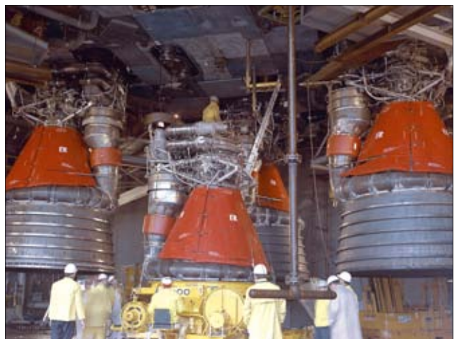
Монтаж ЖРД F-1 на испытательном стенде первой ступени «Сатурна-5»
