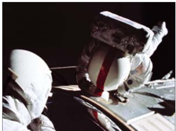
25 апреля на трассе Луна – Земля Томас Маттингли выполнил выход в открытый космос и забрал пленки картографической и панорамной камеры в боковом отсеке служебного модуля.
