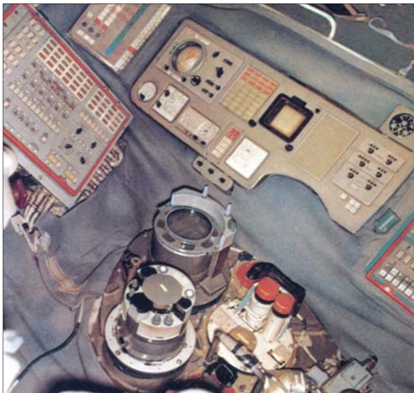
Центральный пост управления на станции «Салют»
