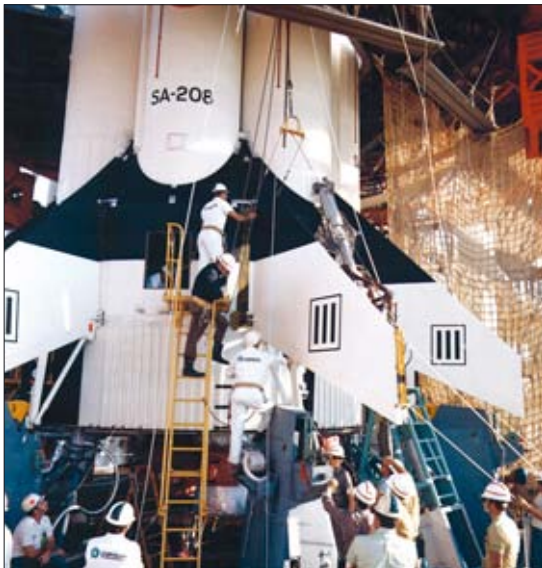
Замена стабилизаторов на РН «Сатурн-1В»
