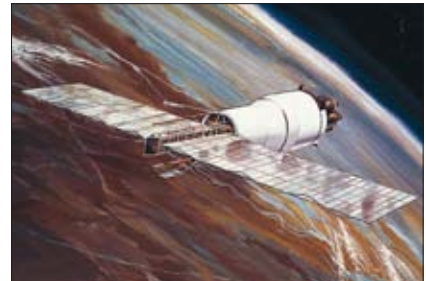
Исследовательский спутник Pegasus содержал детекторы микрометеоритов
