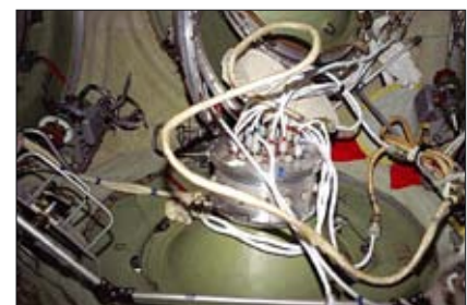
Гермоплата, установленная на люк «Спектра»
