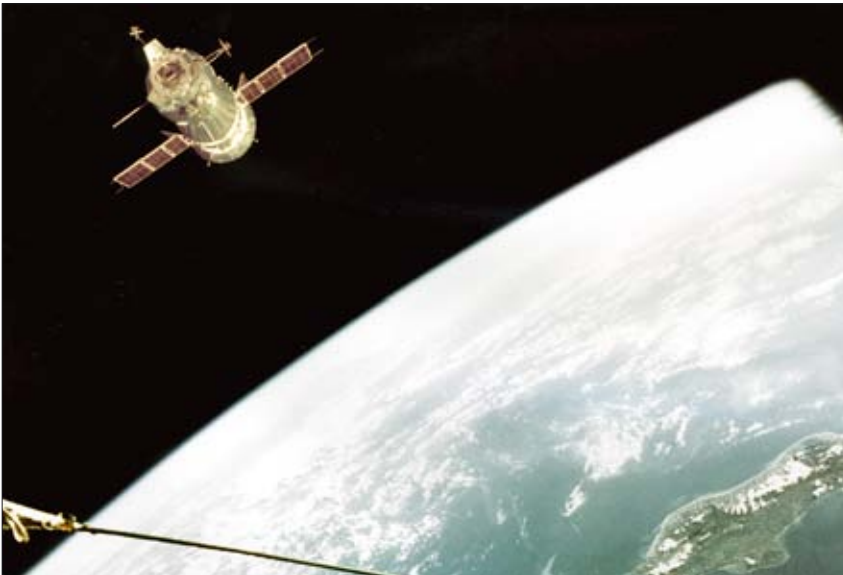
«Союз ТМ-16» с андрогинно-периферийным стыковочным узлом АПАС-89
