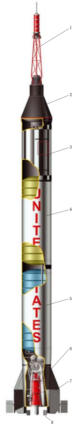
1 – САС; 2 – капсула «Меркурий»; 3 – отсек системы управления; 4 – бак горючего; 5 – бак окислителя; 6 – двигатель; 7 – аэродинамические стабилизаторы; 8 – газовые рули
