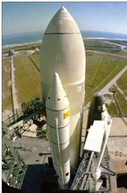
В двух первых полетах «Колумбии» внешний бак красили в белый цвет. Потом было решено бак не красить – это дало прибавку массы полезного груза в 269 кг
