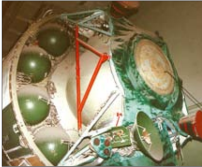
Сферическая шлюзовая камера со стыковочным узлом
