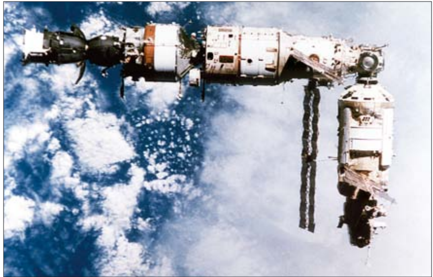
Комплекс «Мир»: Базовый блок, «Квант», Квант-2». Хорошо виден «Союз ТМ-9» с оторванными матами экранно-вакуумной теплоизоляции
