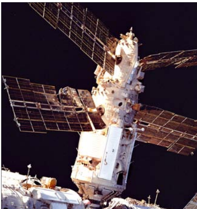
Модуль «Спектр» и его солнечная батарея после столкновения с «Прогрессом М-34»
