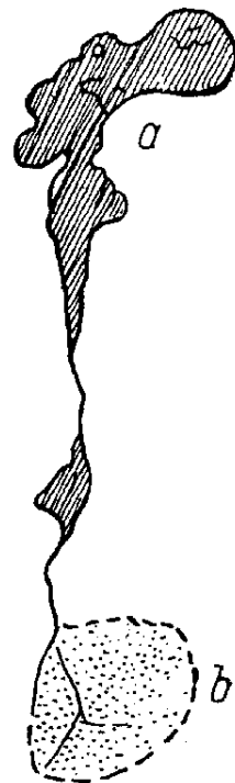
Фиг. 32. Металлическое включение a в 6-м экземпляре.
