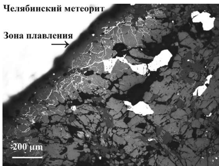
Рис. 1. Микрофото аншлифа, вверху слева — кора плавления
