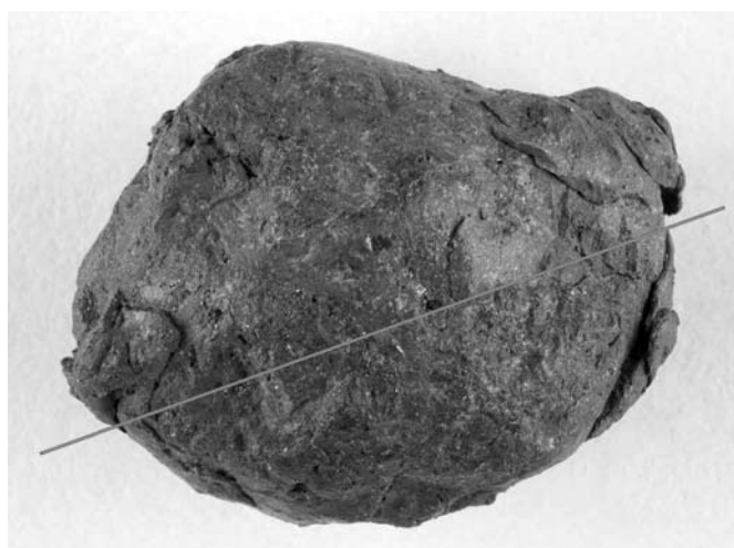
Рис. 2. Фрагмент, представляющий петрологический тип В до распила. На фотографии видна стекловатая текстура образца и приблизительная линия распила. Размер образца 19 мм
