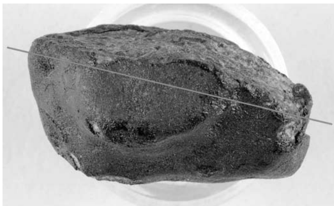
Рис. 1. Фрагмент, представленный петрологическим типом А, и приблизительная линия распила. Образец удерживается на круглой пластиковой подложке. Размер образца 19 мм
