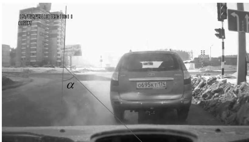
Рис. 1. Тень от ребра здания на горизонтальной поверхности дороги. Угол \alpha чувствителен к азимуту болида и принимает нулевое значение в момент совпадения азимутов болида и ребра здания
