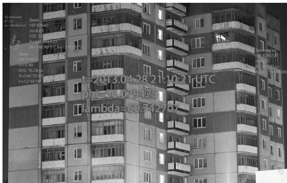
Рис. 5. Определение азимутов ребер дома по звездам HIP 87640 и HIP 82951A. Азимут левого ребра равен 146,95^\circ \pm 0,01^\circ , азимут правого ребра — 161,551^\circ \pm 0,008^\circ .
