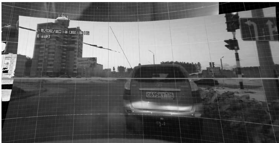
Рис. 7. Пример наложения альт-азимутальной сетки. Сначала находятся параметры калибровочного снимка со звездным небом, затем кадр из видеозаписи совмещается по очертаниям предметов с калибровочным кадром, после чего наносится альт-азимутальная сетка
