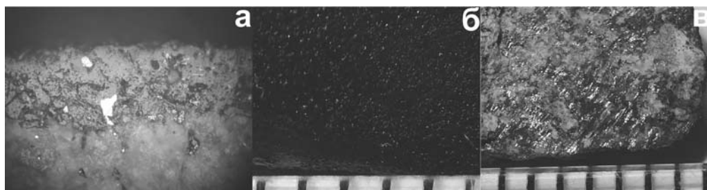
Рис. 2. Термогенная кайма: a — под биноклем хорошо видно обилие трещин и пор, ширина поля зрения 0,7 мм; б — пористая поверхность термогенной каймы; в — кора плавления, похожая на «зеркало скольжения»
