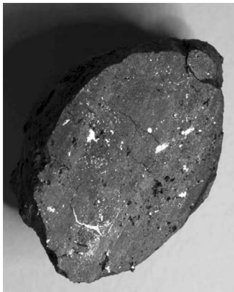
Рис. 4. Поверхность распила образца петрологического типа В, который также имеет наибольший размер — 19 мм. Видны многочисленные вкрапления сульфидов
