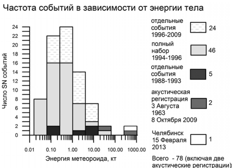
Рис. 7. Распределение спутниковых болидов по энергии: полные данные за 1994—1996 гг. — светло-серые; отдельные события 1988—1993 гг. — черные; отдельные события 1996—2009 гг. — с пунктиром. Только акустические данные — индонезийский болид 2009 г., болид островов Принца Эдуарда 1963 г. — темно-серые. Челябинский болид — белый
