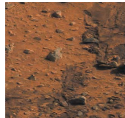
ТЕМНЫЕ СЛЕДЫ, оставленные воздушными подушками, говорят о когезионности почвы: возможно, она представляет собой пыль, связанную электростатическими силами, или слабо сцементированную «корку» наподобие той, что обнаружил Viking .
