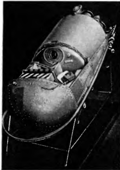
Рис. 1. Катапультируемый контейнер для подопытных животных
