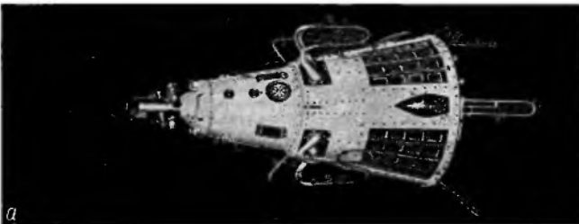
Рис. 4. Третий ИСЗ: а — общий вид; б — схема; 1 — магнитометр; 2 — фотоумножители для регистрации корпускулярного излучения Солнца; 3 — солнечные батареи; 4 — прибор для регистрации фотонов в космических лучах; 5 — магнитный и ионизационный манометры; 6 — ионные ловушки; 7 — электростатические флюксометры; 8 — прибор для регистрации тяжёлых ядер в космических лучах; 9 — датчики для регистрации микрометеоров, электронные блоки научной аппаратуры, радиоизмерительные системы, программно-временное устройство и электрохимические источники питания расположены внутри корпуса спутника; 10 — прибор для измерения интенсивности первичного космического излучения; 11 — масс-спектрометрическая трубка
