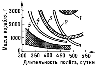
Длительность полёта на Марс и начальная масса КК, стартующего с орбиты Земли, при использовании различных РД: 1 — ЖРД; 2 — ЭРД; 3 — твердофазный ЯРД; 4 — сочетание ЭРД с твердофазными ЯРД; 5 — газофазный ЯРД
