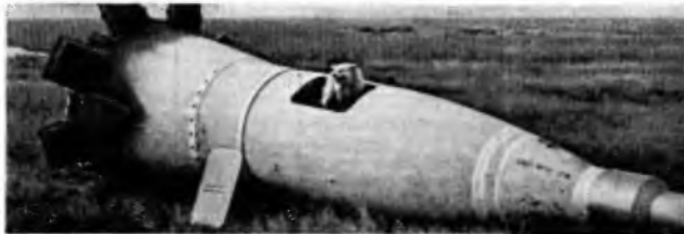
Головная часть геофизической ракеты Р-2А с собакой Пёстрая (после приземления)
