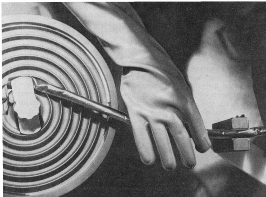
Рис. 26. Грунтонос с грунтом, доставленным автоматической станцией «Луна-24»
