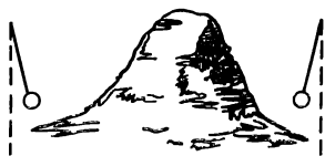
Рис. 49. Отклонение отвеса у горного хребта
