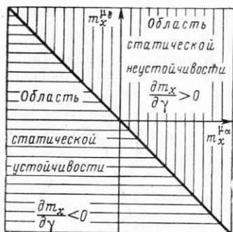
Рис. 6.3. Область статической устойчивости по крену при круговой симметрии продольно-бокового момента
