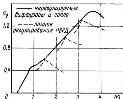
Рис. 23.4. Скоростная характеристика ПВРД
