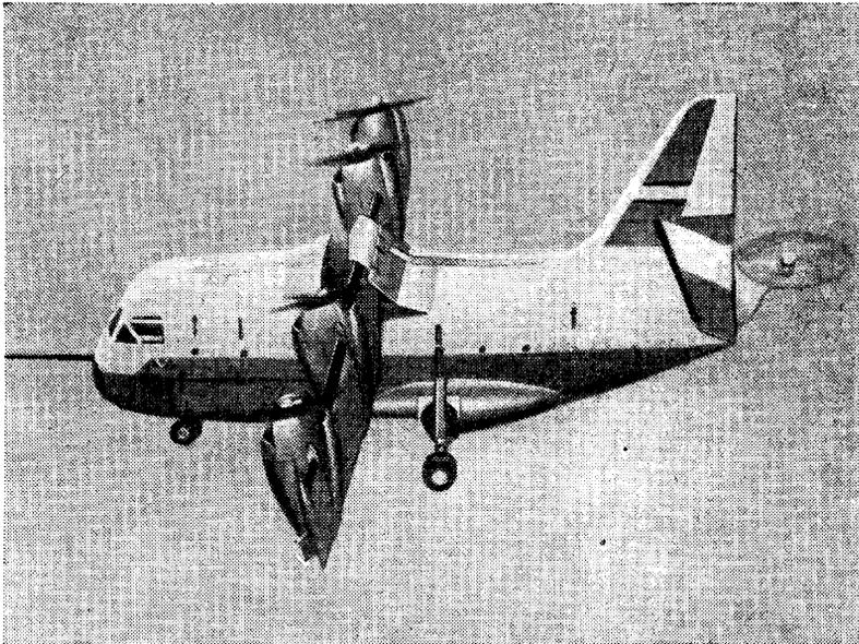
Рис. 22.11. Винтовой самолет с поворачивающимися крыльями Воут XE-142 (США). Положение крыльев окончательное — стартовое или посадочное
