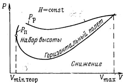
Рис. 9.6. Режимы полета на диаграмме потребных и располагаемых тяг (упрощенный метод тяг)
