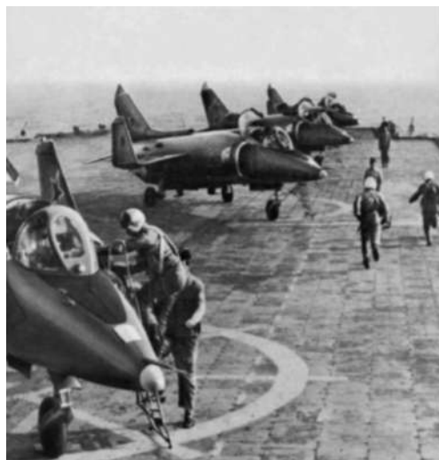
1. Палубный истребитель Як-38, двигатель Р27 В, САУ-55В 2. Истребители Як-38 на палубе противолодочного крейсера
