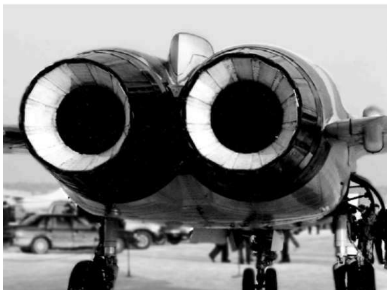
1. Многофункциональный самолет МФИ с двигателями АЛ-41Ф и САУ-41 2. Агрегаты САУ 41
