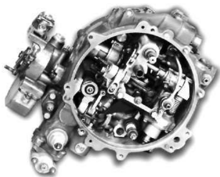
1. Гидромеханический счетнорешающий механизм «паук» 2. Конструктор Е.Н.Каленов
