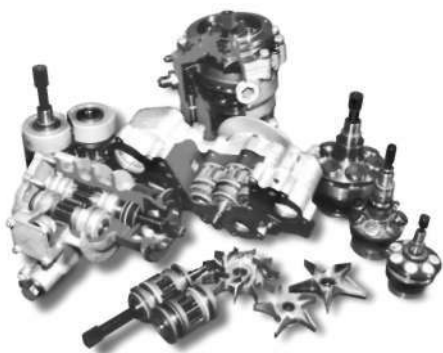
Элементы плунжерных, шестеренных и центробежных качающих узлов
