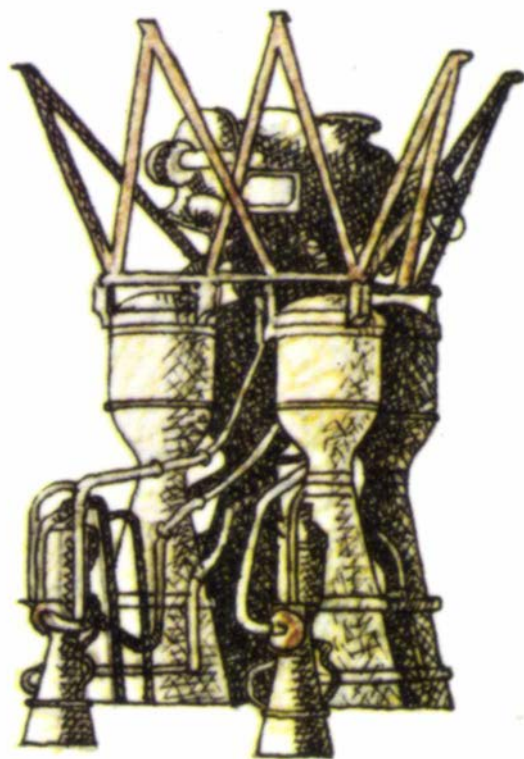
Огромная мощность, высокая надёжность, выносливость — этими качествами обладает ракетный двигатель РД-107.
