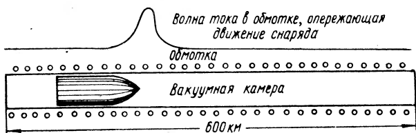
Рис. 4. Принцип действия электромагнитной пушки.
