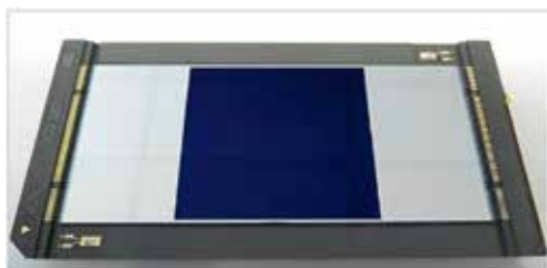
Рис. 3.36. ПЗ-приемник CCD282 фирмы e2v с электронным усилением формата 4096 \times 4096 пикселей
