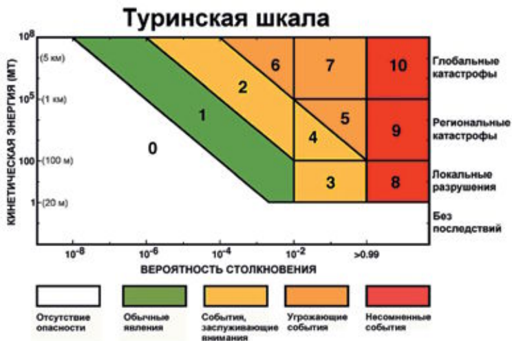
Рис. 1.8. Туринская шкала для оценивания угрозы столкновений астероидов и комет с Землей в ближайшие примерно 100 лет
