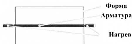
Рис. П2.8. Растяжение арматуры
