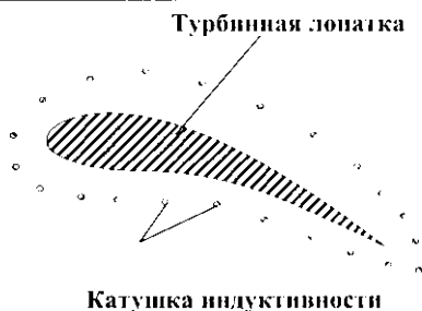
Рис. 5.7. Определение скрытых дефектов
