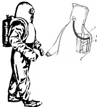
Рис. 6.55. Газотеплозащитный костюм для горноспасателей. Изобретение Г. С. Альтшуллета. А.с. 111 144.
