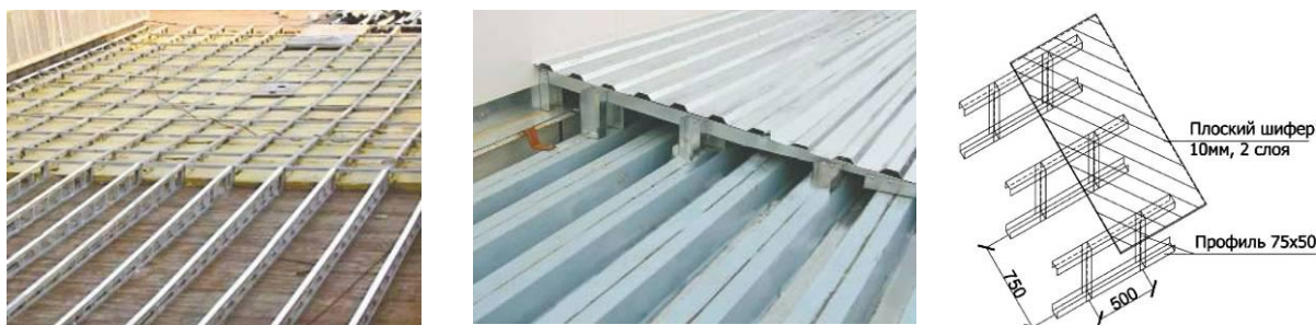
Рис. 2.16. Варианты устройства сборных разуклонок
