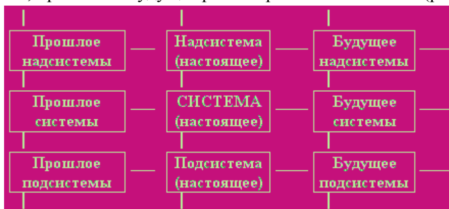
Рис. 4.1. Системный оператор можно применять для прогнозирования. Прогнозы на одном уровне должны согласовываться с прогнозами на других уровнях
