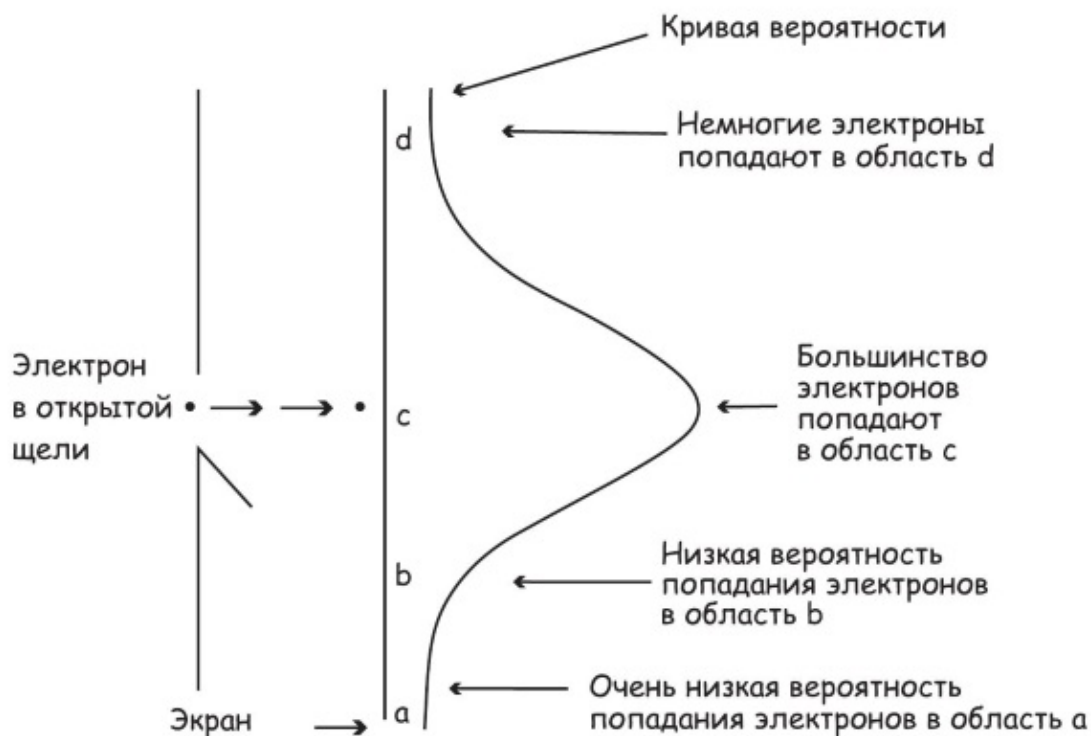
Рис. 14.2. Кривая вероятности в случае, когда открыта одна щель
