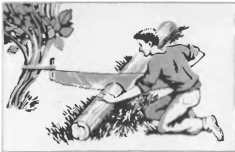
Рис. 17. Как пилить двуручной пилой одному
