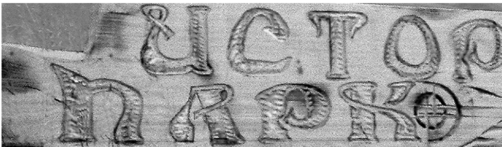
Фото 3.6. Нанесенные вручную риски придают объем и дополнительную фактуру элементам, созданным с помощью фрезы («Аркаим»).
