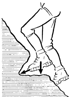
Рис. 2. Распределение сил при вытаптывании ступени в рыхлом снегу
