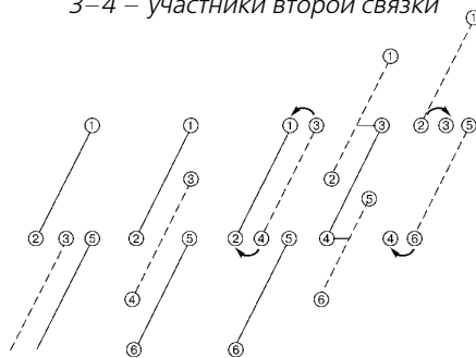
Рис. 23. Схема взаимодействия трёх связок-двоек без смены ведущего
