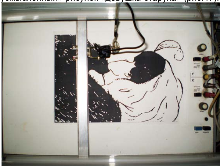
Рис.47. Двухкоординатный самописец с находящимся на его рабочем поле исследуемым рисунком.
