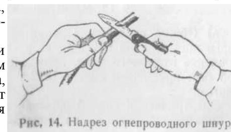
Рис. 14. Надрез огнепроводного шнура
