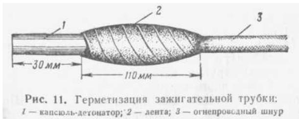
Рис. 11. Герметизация зажигательной трубки: 1 — капсюль-детонатор; 2 — лента; 3 — огнепроводный шнур
