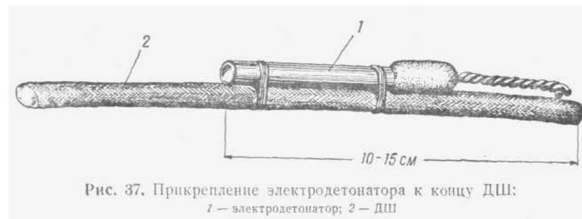
Рис. 37. Прикрепление электродетонатора к концу ДШ:
