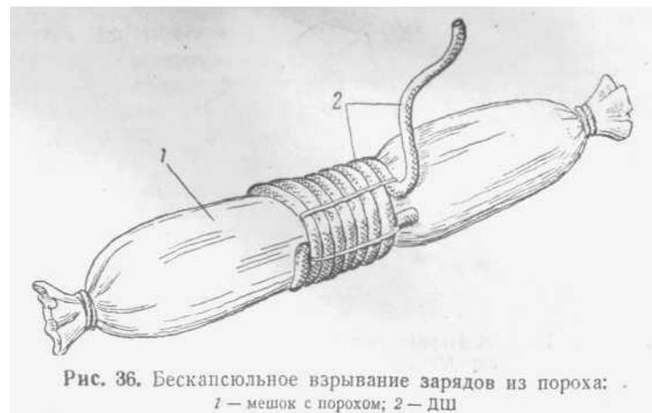
Рис. 36. Бескапсюльное взрывание зарядов из пороха:
