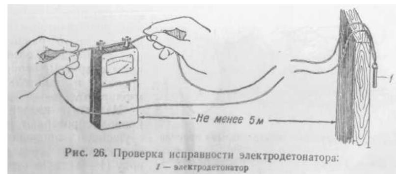
Рис. 26. Проверка исправности электродетонатора:
