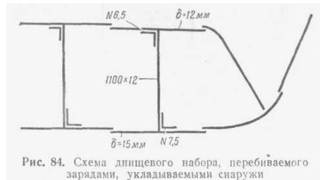
Рис. 84. Схема днищевого набора, перебиваемого зарядами, укладываемыми снаружи
