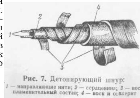
Рис. 7. Детонирующий шнур:
