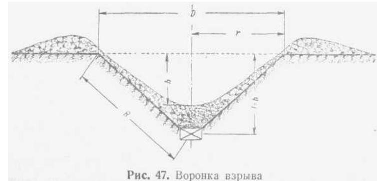
Рис. 47. Воронка взрыва
