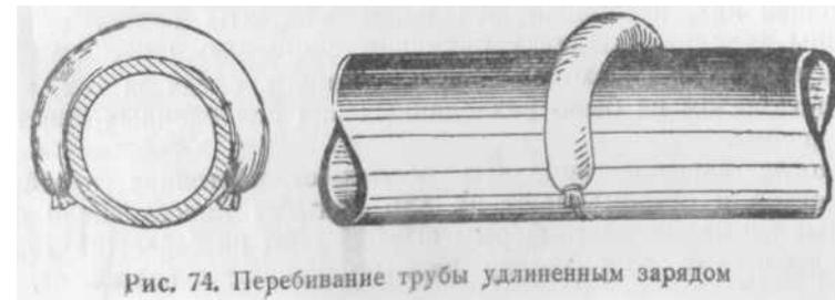
Рис. 74. Перебивание трубы удлиненным зарядом
