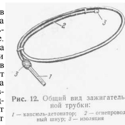
Рис. 12. Общий вид зажигательной трубки:
