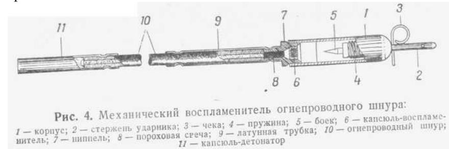
Рис. 4. Механический воспламенитель огнепроводного шнура:
