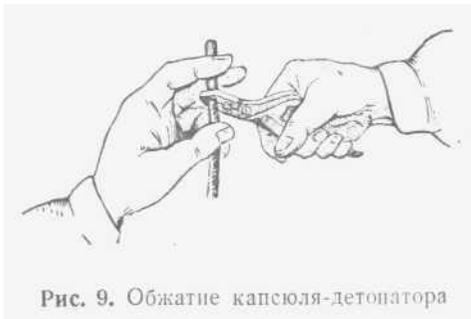
Рис. 9. Обжатие капсюля-детонатора
