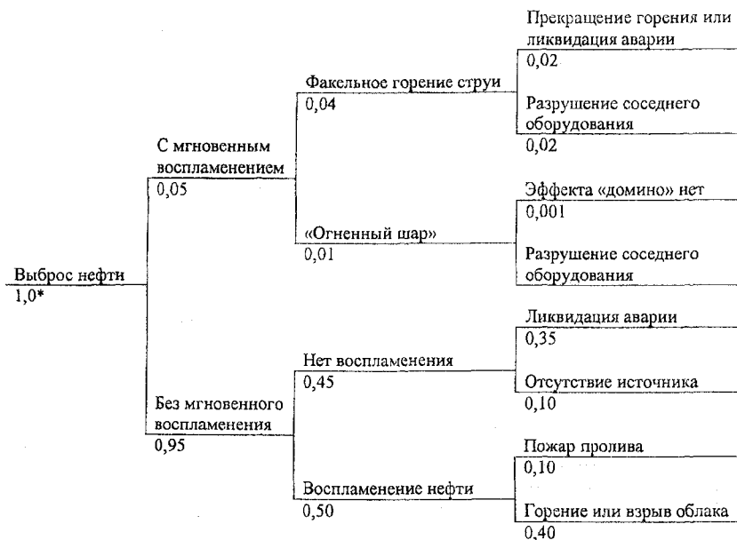
Рис. 20. «Дерево событий» аварий на установке первичной переработки нефти
