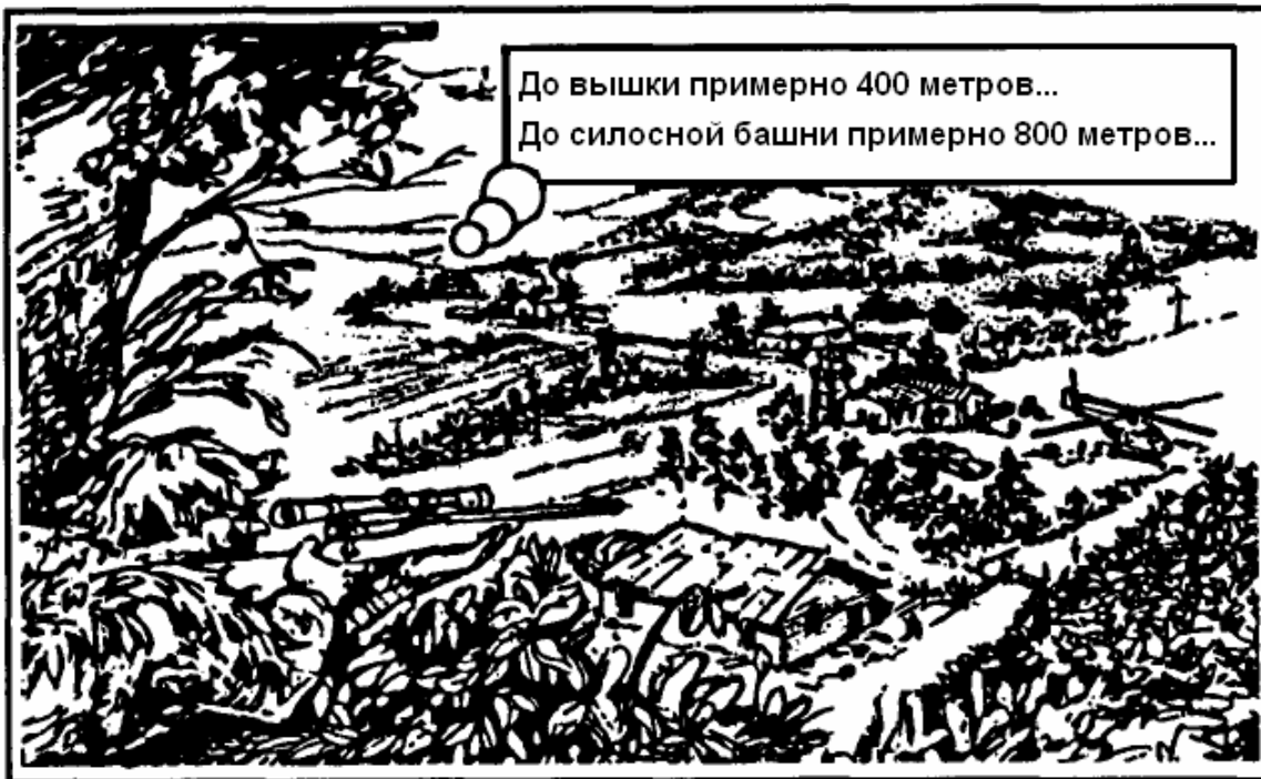
Рис. 4-18. Способ измерения 100-метровыми отрезками.
