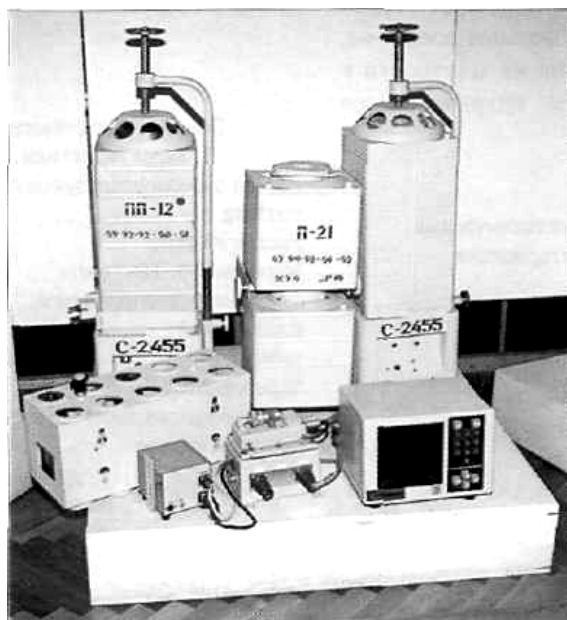
Рис. 43. Система химической регенерации воздуха С-2.455.
