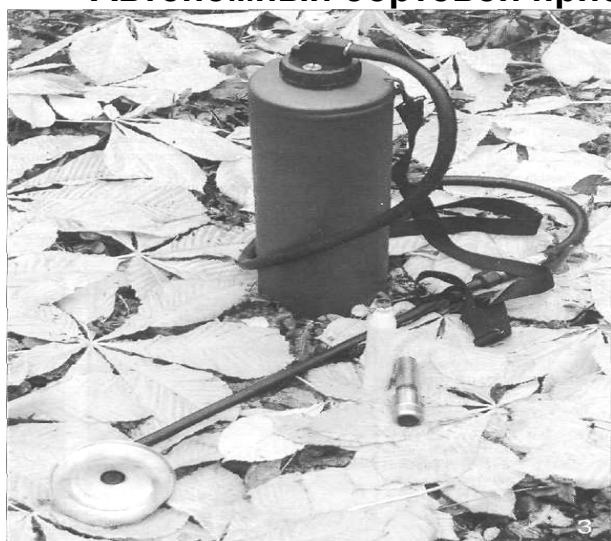
Рис. 85. Автономный бортовой прибор специальной обработки.
