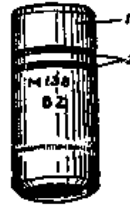
Рис. 4. Химическая бомба M138: 1 – корпус; 2 – два красных кольца
