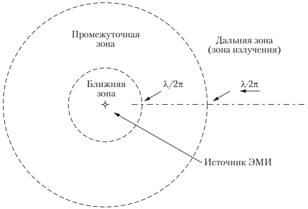
Рис. 2.11. Зоны, возникающие вокруг элементарного источника ЭМИ
