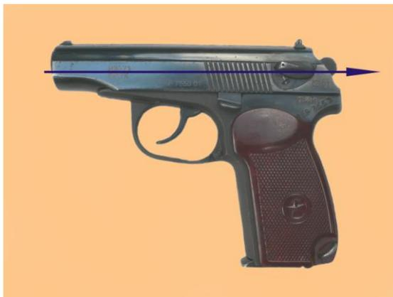
2. **Сила проворачивания** пистолета вокруг центра его масс, возникающая из-за того, что задний упор рукоятки пистолета расположен ниже оси ствола, а также из-за встречидвигающегося кожуха-затвора с ограничительным упором (Рис. 4).
