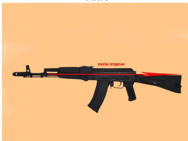
**2. Сила проворачивания** автомата вокруг центра его масс, возникающая при встрече двигающейся затворной рамы с задним ограничительным упором, т. к. удар происходит выше оси ствола, а задний упор пистолетной рукоятки автомата расположен ниже оси ствола, что приводит к запрокидыванию ствола автомата вверх, а также из-за того, что затыльник приклада расположен ниже оси ствола (Рис. 4).
