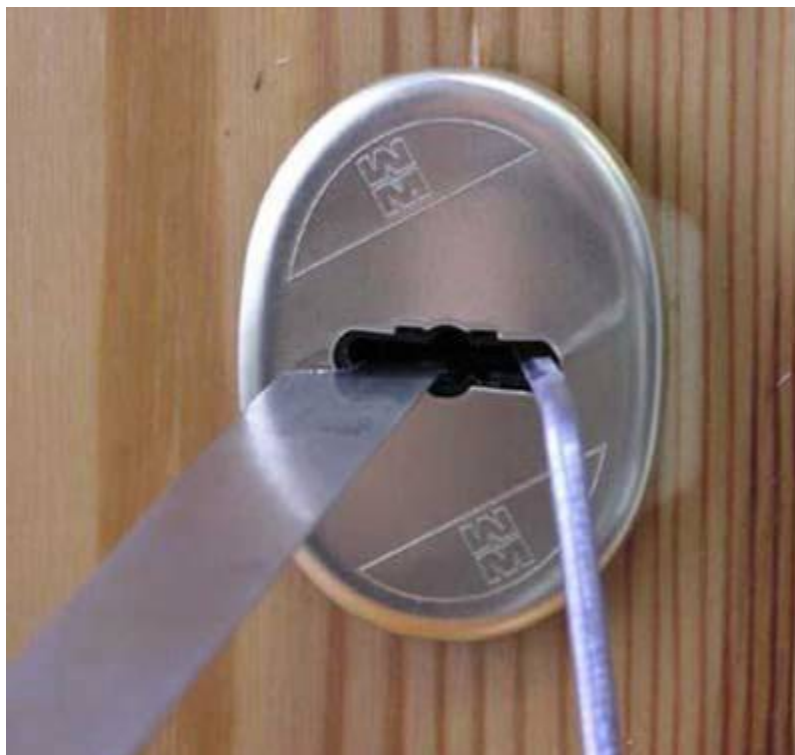
Фото 8. На фотографии вы видите процесс снятия слепка с замка Мойига.
