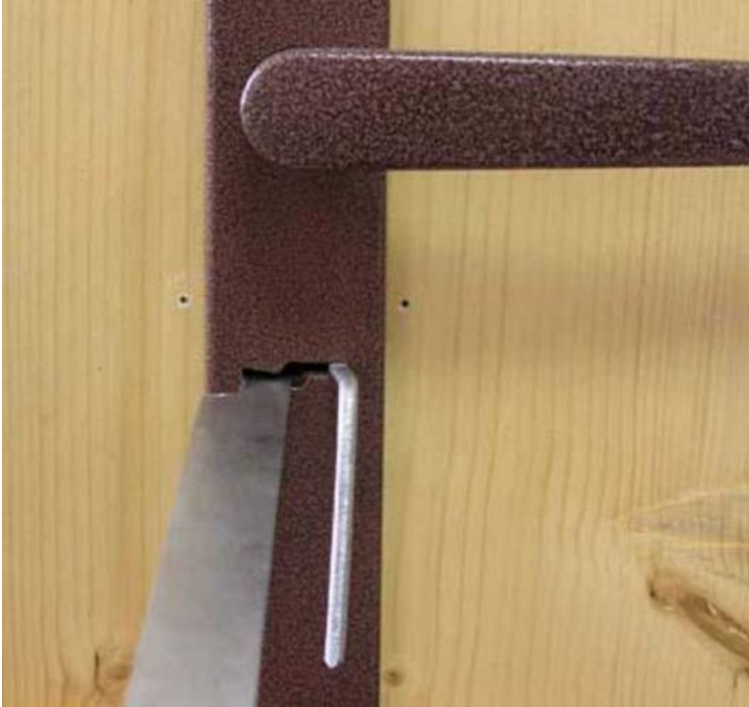
Фото 4. На фотографии вы видите процесс снятия слепка с замка Меттэм, где применяется не симметричный способ нарезки комбинаций.
