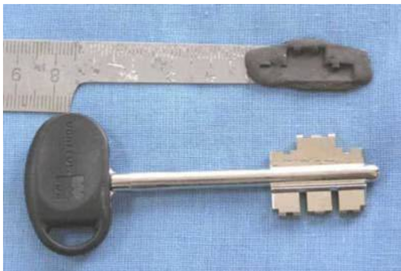
Фото 9. На фотографии вы видите полученный слепок. Т.к. ключ не симметричный, надо снять слепок с другой половины бородки ключа.
