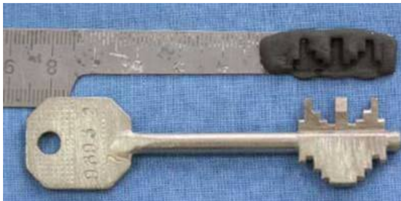
Фото 5. На фотографии вы видите полученный слепок. Т.к. ключ не симметричный, надо снять слепок с другой половины бородки ключа.
