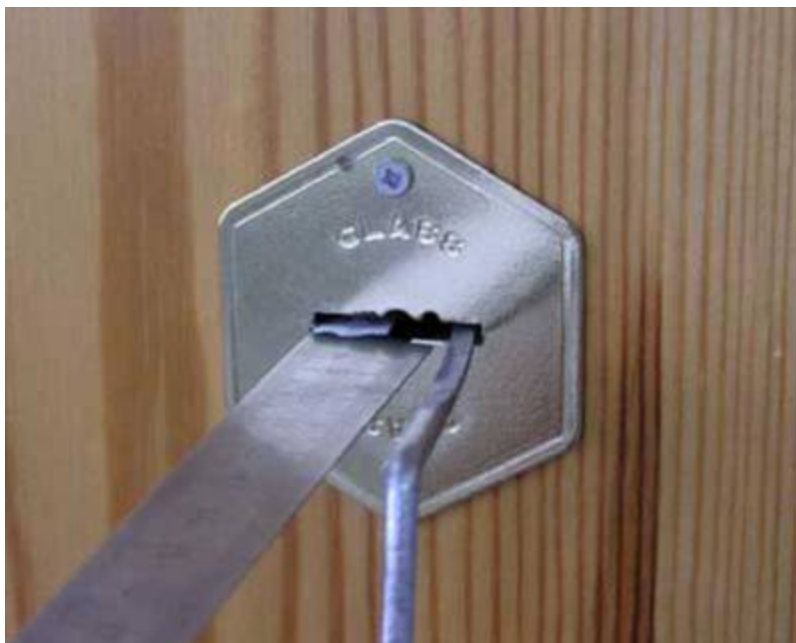
Фото 6. На фотографии вы видите процесс снятия слепка с замка Class.
