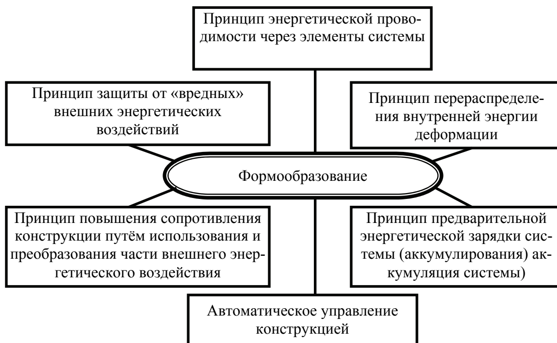
Рис. 6. Схема энергетических принципов активного формообразования конструкций
