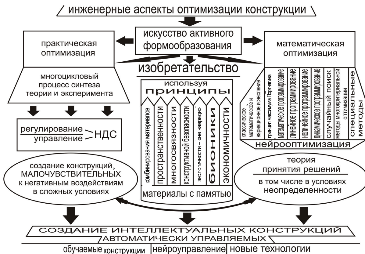
Рис. 19. Инженерные аспекты оптимизации конструкции
