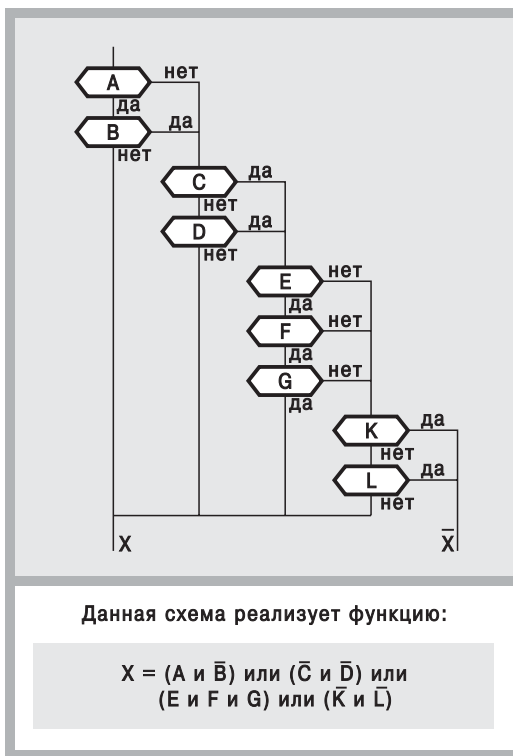
Рис. 69. Пример сложной логической функции
