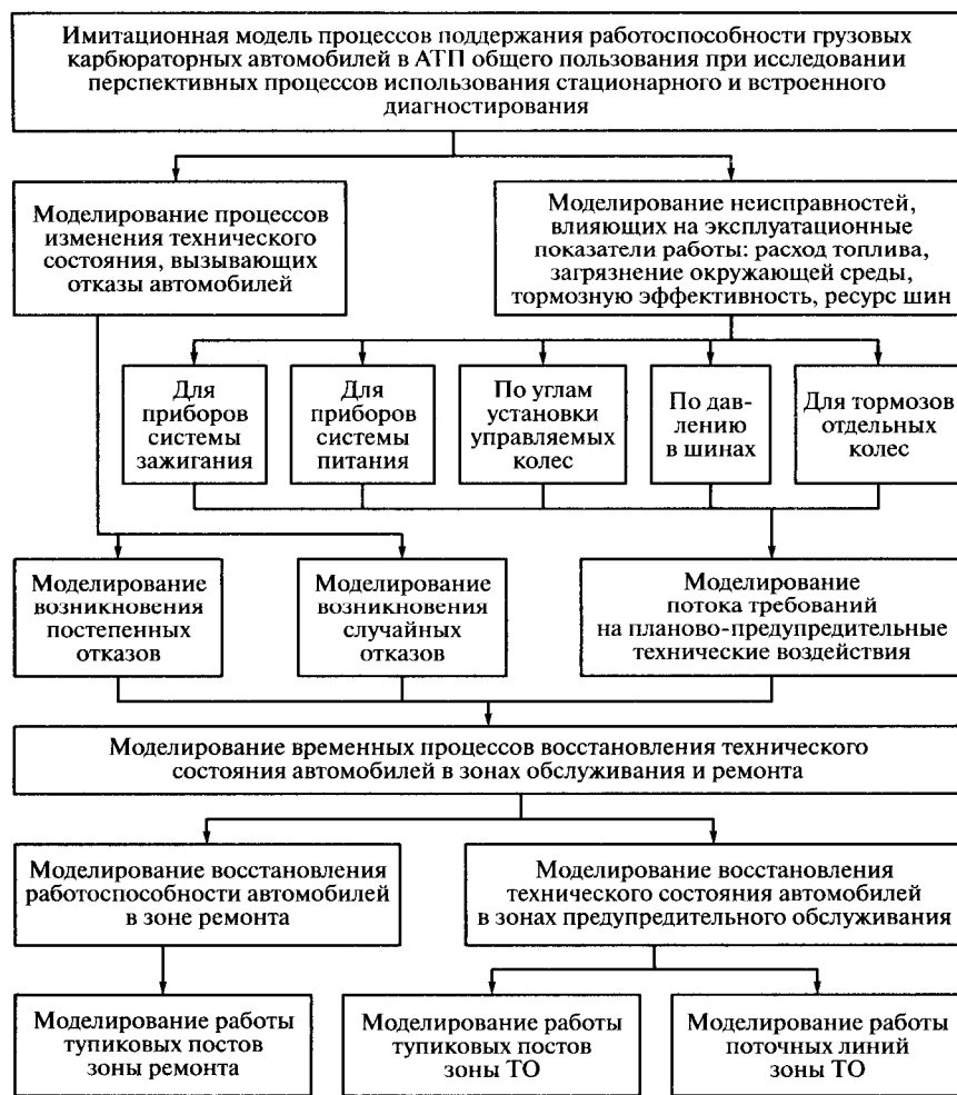
Рис. 7.2. Структурная схема проведения имитационного моделирования для АТП общего пользования
