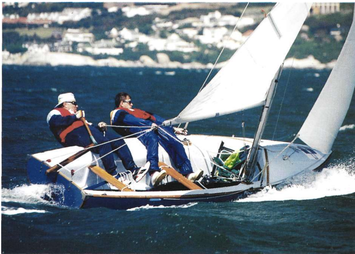
Использование блоков на этой плосколонке уменьшает усилие, необходимое для выбирания гика-шкота
