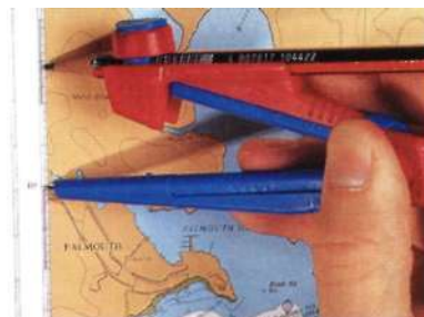
Для вычерчивания дуги опасности определяется безопасное расстояние, измеренное по шкале широт сбоку морской карты
