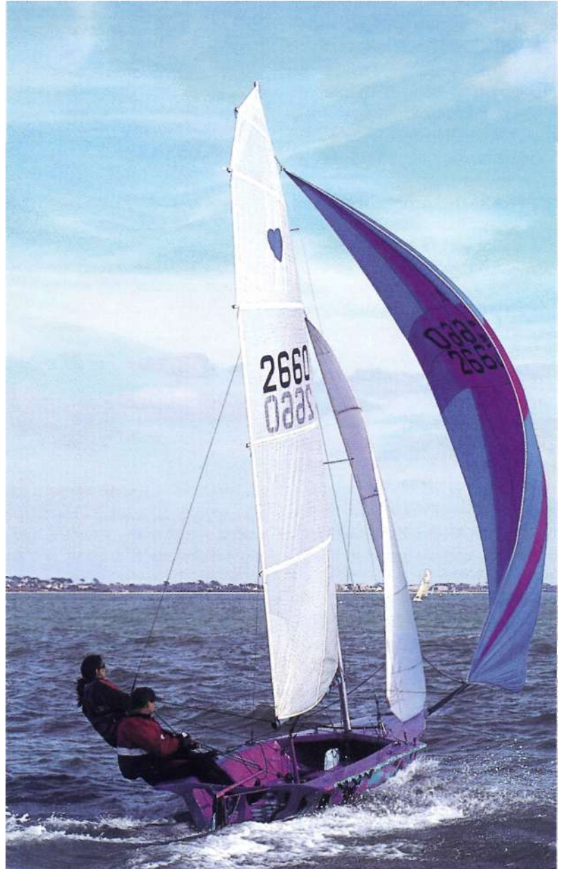
Так как парус имеет форму крыла самолета, воздух движется быстрее с наружной стороны изгиба, создавая водоворот, толкающий лодку вперед
