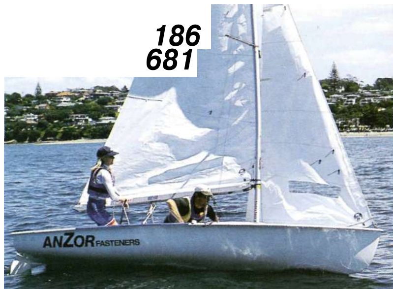
Лодка оказалась в застойной зоне, носом непосредственно против ветра, - это аналогично ситуации, когда у автомобиля глохнет двигатель. Чтобы опять начать двигаться, толкните румпель от себя и перекиньте стаксель на другую сторону, так, чтобы парус мог поймать ветер внутренней стороной
