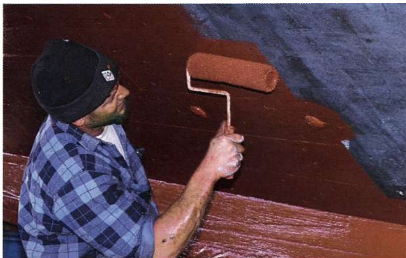
Подготовка поверхности с помощью наждачной бумаги и нанесение защитного слоя помогут пролить срок службы и улучшить внешний вид деревянного корпуса
