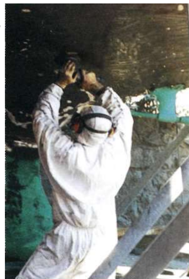
Подготовка поверхности с помощью наждачной бумаги и нанесение защитного слоя помогут пролить срок службы и улучшить внешний вид деревянного корпуса
