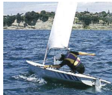
При подготовке к повороту фордевинд потяните румпель к себе, управляя гротом с помощью гика-шкота, когда парус пересекает лодку
