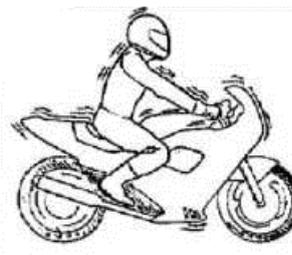
**Рис. 71.** Гонщик напряжен – колебания через его тело передаются на весь мотоцикл
