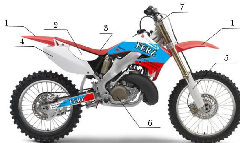
Рис. 108. Мотоцикл для мотофристайла с доработанными деталями (см. пояснения в тексте)
