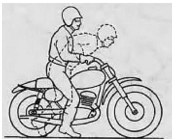
**Рис. 83.** Изменение положения тела гонщика в момент начала движения после стартового сигнала (пунктирный контур)
