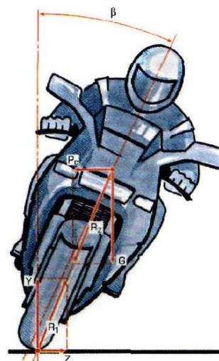
Рис. 27. Силы, действующие на мотоцикл в повороте:  $Y$  – вертикальная составляющая опорной реакции колеса;  $Z$  – поперечная составляющая опорной реакции колеса;  $R_1$  – результирующая опорной реакции колеса;  $R_z$  – результирующая центробежной силы и веса мотоцикла;  $G$  – вес мотоцикла с водителем;  $P_c$  – центробежная сила;  $\beta$  – угол наклона мотоцикла
