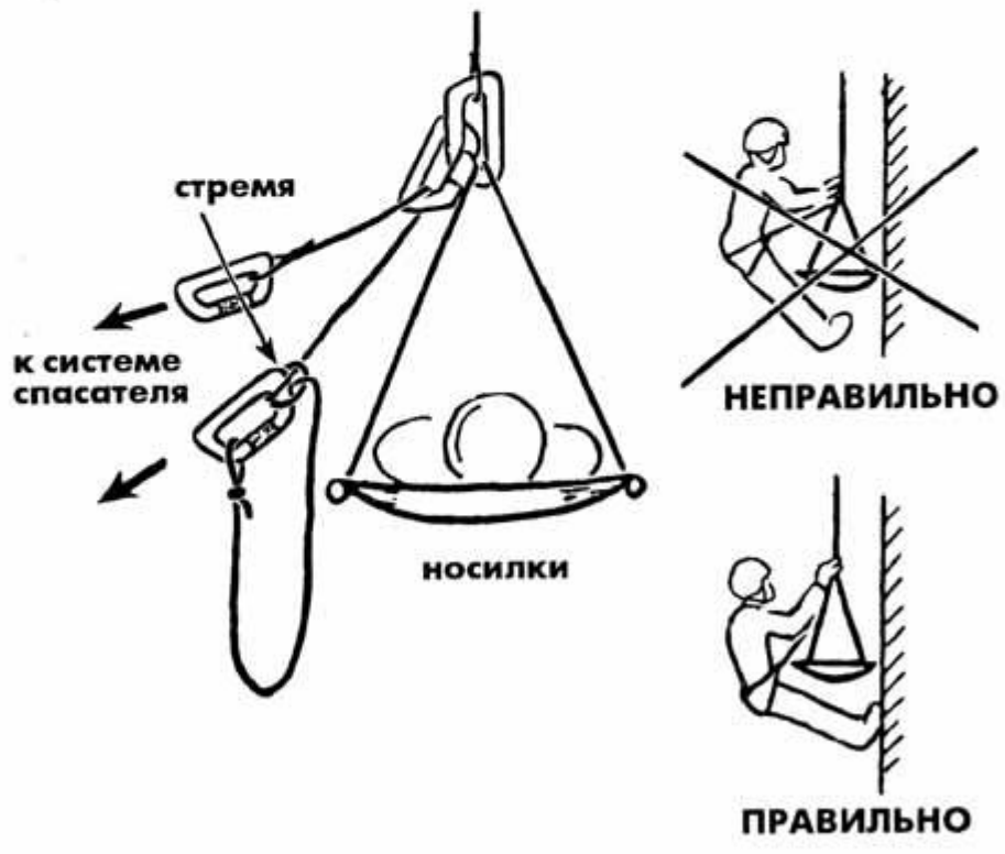
Присоединение спасателя: а – при транспортировке сидя; б – при транспортировке лежа (например, в носилках)
