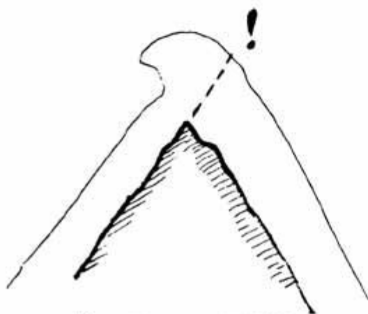
Линия отрыва карниза
