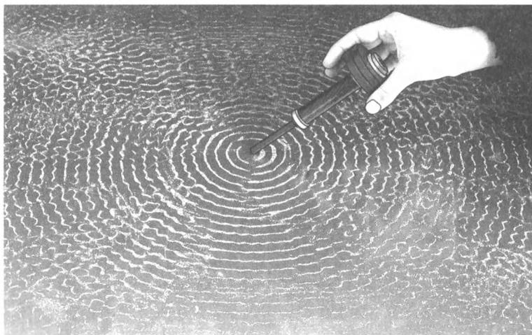
Рис. 10.18. Концентрические линии обозначаются порошком в результате касания поверхности тонкой пластинки наклонным излучателем
