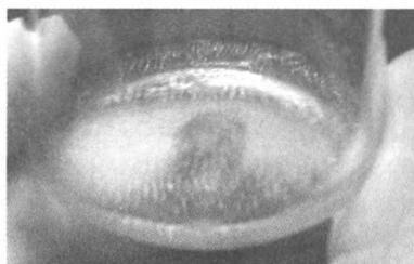
Рис. 13.6. Капиллярные волны на поверхности ацетона в химическом стакане
