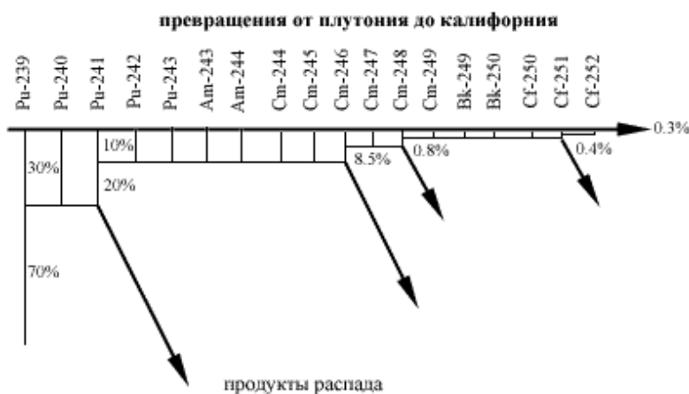
Рис.2 Ядерные превращения при переходе от плутония к калифорнию
