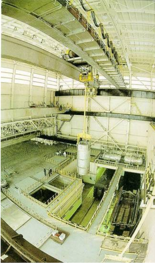
Рис.7 Выгрузка из железнодорожного вагона контейнера с отработавшим ядерным топливом на радиохимическом заводе (ГХК)
