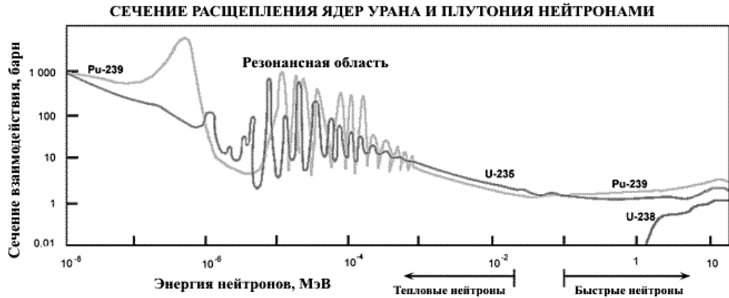
Рис.4 Энергетическая зависимость сечений ядерных реакций в уране-235 и плутонии-239, протекающих с участием нейтронов.
