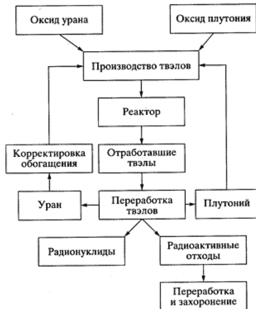
Рис.2. Схема производства и «сжигания» МОКС-топлива в быстрых реакторах
