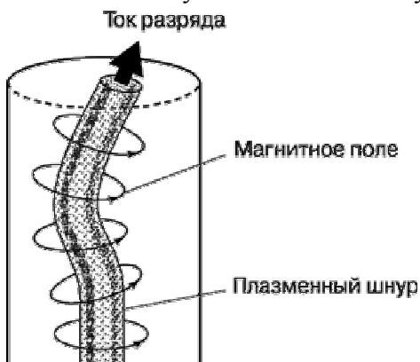
Рис.10 Неустойчивый плазменный шнур. Силовые линии магнитного поля сгущаются с вогнутой стороны, усиливая изгиб.
