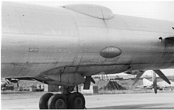
Рис.28. Ту-95ЛАЛ. Обтекатели и воздухозаборник реактора
