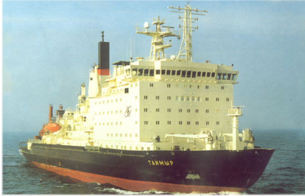
Фото 8. «Таймыр» - атомный ледокол с малой осадкой
