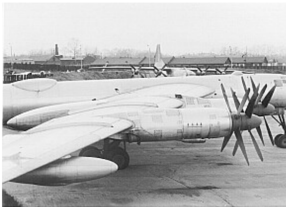
Рис.27 Ту-95ЛАЛ. На переднем плане -контейнер с датчиком излучения
