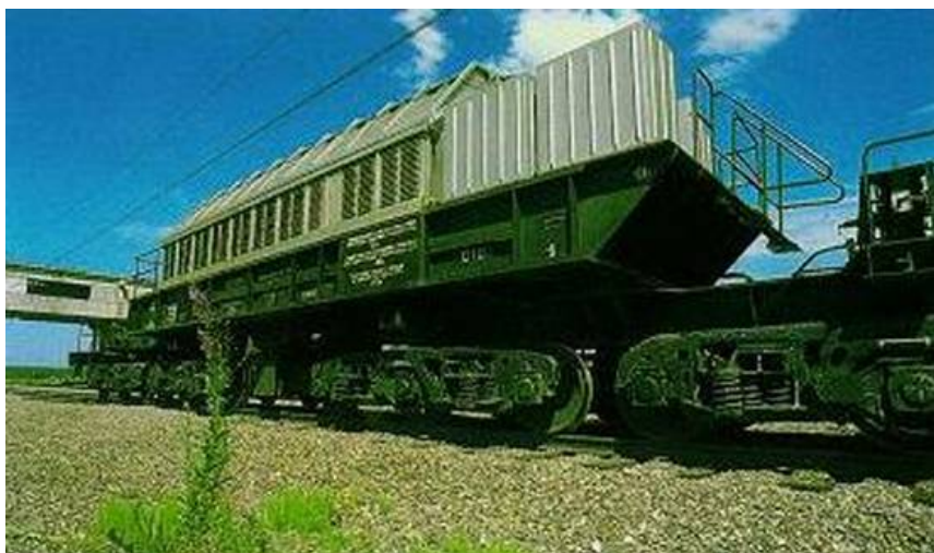
Рис.6 Вагон для перевозки ОЯТ по железной дороге
