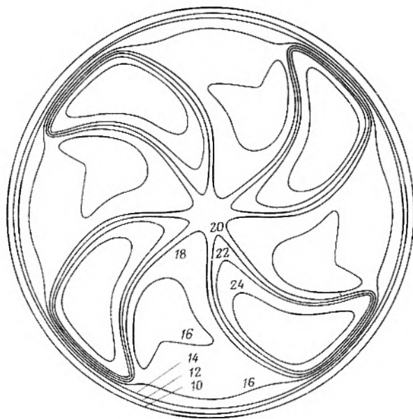
Р и с. 84. Топография магнитного поля в medianной плоскости циклотрона с секторной фокусировкой на 50 Мэв. Цифры на контурных линиях означают напряженности поля в килогауссах [16].
