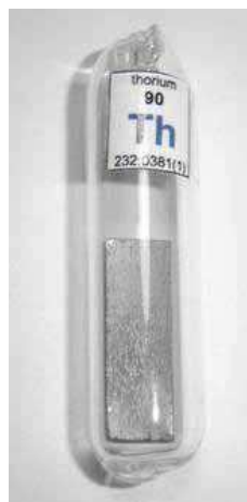
Рис. 4. Чистый торий – блестящий серебристый метал. При выдержке в течение нескольких месяцев на воздухе темнеет. Фото ториевой фольги (0,5 мм толщиной), запаянной в ампулу в атмосфере аргона.
