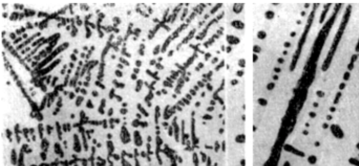
Рис. 19. Микроструктура сплавов системы торий-кислород: слева - структура образца после дуговой плавки. Образец содержал от 4 до 12% кислорода; при охлаждении произошел процесс сегрегации. Механическая полировка на шелке с окисью алюминия; справа - сплав с 20% кислорода, закаленный с 1100° С. Механическая полировка алмазной пастой.
