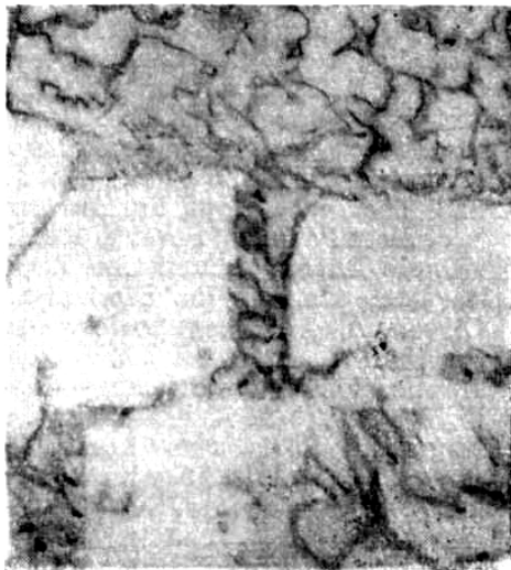
Рис. 21. Структура литого сплава тория с 42 ат.% алюминия. Зерна \text{Th}_3\text{Al}_2 окружены эвтектикой из \text{Th}_3\text{Al}_{12} - \text{ThAl}_2 . Механическая полировка с последующим электролитическим.
